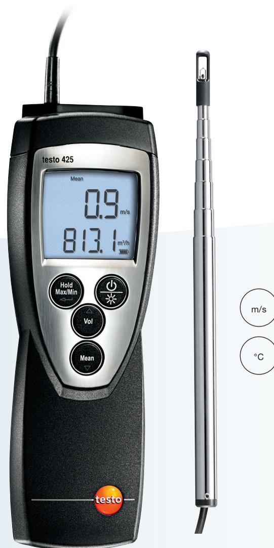
L'anemometro compatto Testo 425 è dotato di sonda termica fissa di Ø 7,5 mm per la misura della velocità dell'aria. Lo strumento è particolarmente adatto a misurare la velocità dell'aria nei condotti grazie alla prolunga telescopica di cui è dotato (lunghezza massima 820 mm). Testo 425 è in grado di misurare anche la bassa velocità dell'aria con estrema precisione.
