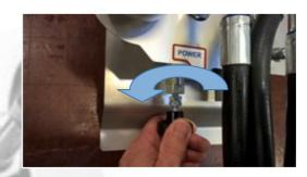
Ruotare la manetta della valvola POWER in senso orario fino all'avvio lento della macchina (tra 40 e 50 bar sul manometro)
