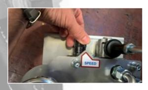
Aprire la valvola dell'aria compressa sulla macchina dopo un lasso di tempo adeguato
