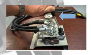
Ruotare la manetta della valvola SPEED in senso antiorario finché la macchina non inizia a funzionare lentamente (circa 1/3-1/2 giro)
