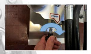
Regolare la velocità fino a trovare quella adeguata ruotando la manetta della valvola SPEED (controllare la lettura m/min della velocità)
