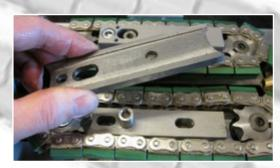
Svitare la vite di Allen nella parte centrale della ruota della catena
