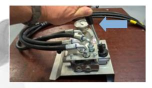
Ruotare la manetta della valvola POWER in senso orario per aggiungere potenza, se necessario
