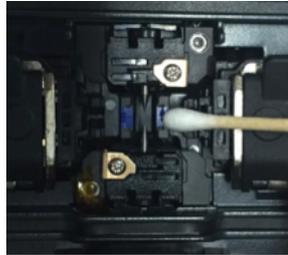
Un V-groove contaminato può causare un incorretto allineamento delle fibre.
