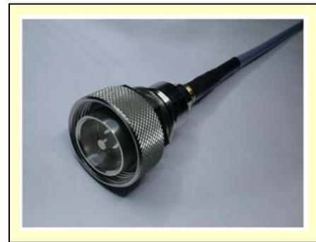
Figura 2 – Cavo NTEQ non corazzato. Dettaglio intestazione connettore N
