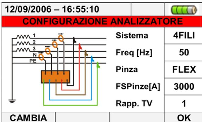
Per ogni sistema di misura in prova gli strumenti forniscono a display uno schema sinottico di aiuto all'operatore nel collegamento all'impianto in esame.
