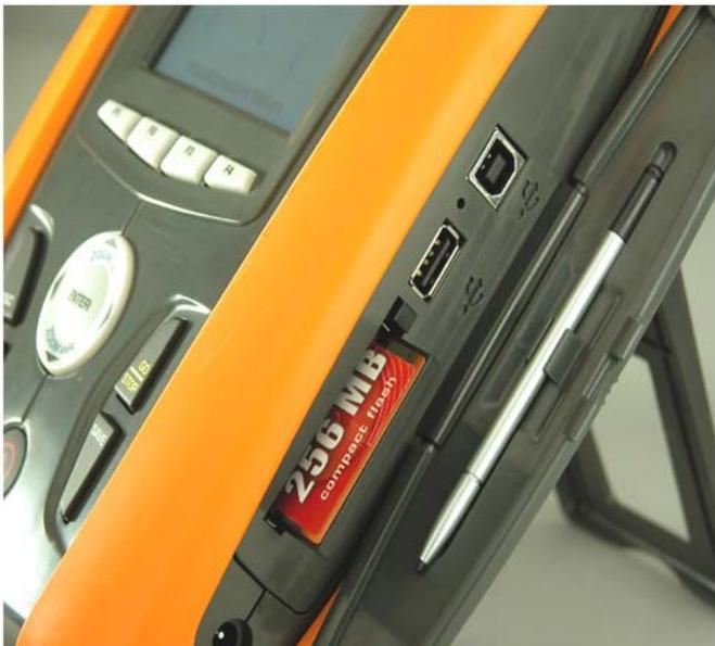
Ogni modello è predisposto per l'inserimento di Compact Flash esterne al fine di espandere in ogni momento la capacità di memoria interna (pari a 15Mbytes). Pen Drive USB possono inoltre essere usati per il trasferimento di registrazioni dalla memoria dello strumento.
