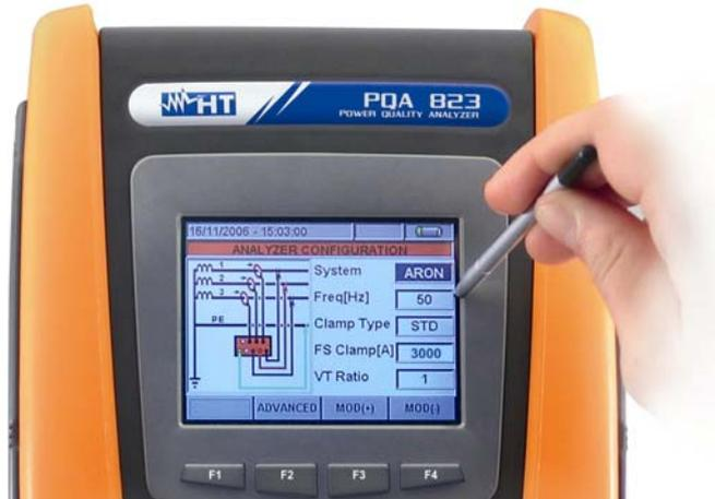
Ogni modello dispone di ampio display grafico a colori TFT (320x240pxls) con “touch screen” per accesso ad ogni funzione con uso dell'apposito puntatore a penna in dotazione
