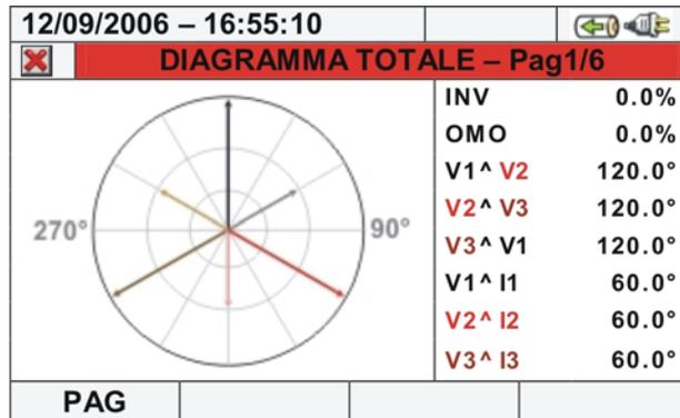
La funzione “Diagramma Vettoriale” disponibile su ogni modello consente di visualizzare il mutuo sfasamento tra i vettori delle tensioni e delle correnti al fine di determinare la natura di un carico
