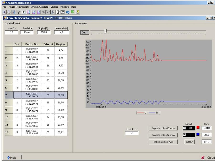
Analisi numerico/grafica degli eventi rilevati dallo strumento sulle correnti di spunto con risoluzione 10ms
