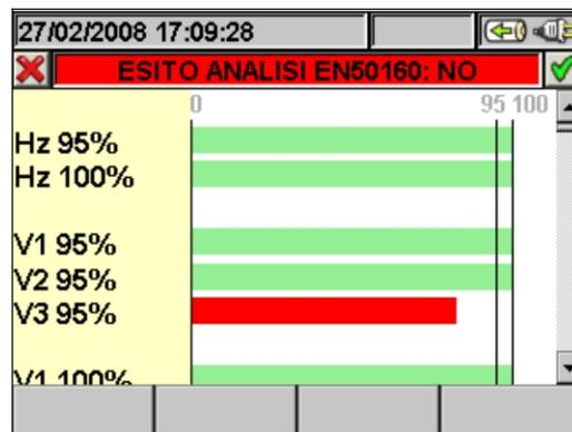
Fig. 140: Iistogramma Analisi EN50160
