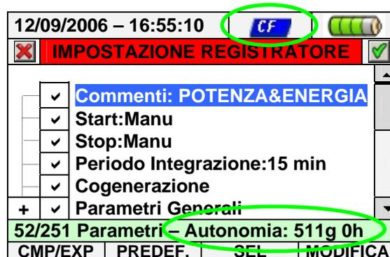
Fig. 196: Esempio di uso della memoria esterna - presenza Compact Flash
