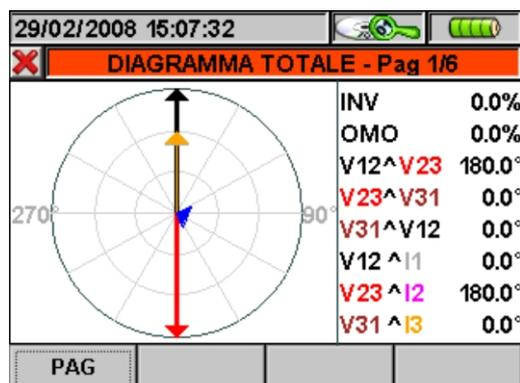
Fig. 167: Diagramma vettoriale di fase in Sistema Monofase
