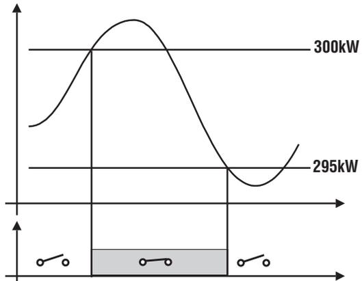
Viene richiesto lo scollegamento di un carico al superamento di un pre-determinato valore di potenza assorbita, per esempio al superamento dei 300kW l'allarme deve intervenire e scollegare un carico predeterminato. Di seguito è riportata la programmazione consigliata:
