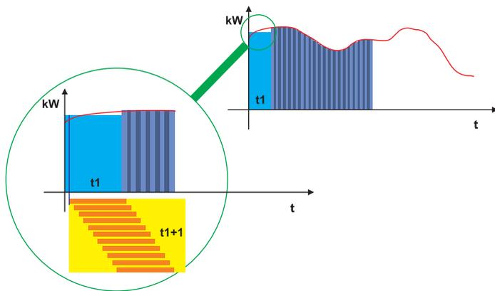
**SELEZIONE SCORREVOLE:** se per esempio si è selezionato un intervallo di tempo di 15 minuti, lo strumento calcola la media e ne aggiorna il valore inizialmente dopo i primi 15 minuti, successivamente ogni minuto generando una finestra della larghezza di 15 minuti che si muove in avanti di 1 minuto alla volta.
