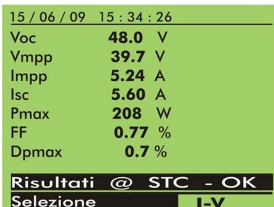
**I-V400w** dispone di ampio display grafico in grado di visualizzare simultaneamente tutte le informazioni necessarie alla valutazione delle CT dei pannelli compreso l'esito OK/NO del confronto con i dati forniti dal costruttore dei pannelli
