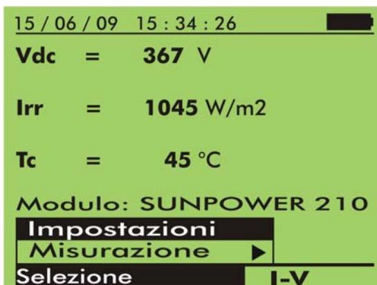
L'interfaccia utente di **I-V400w** è realizzata tramite una gestione a menu interni strutturata a livelli con comode impostazioni tramite tasti funzione
