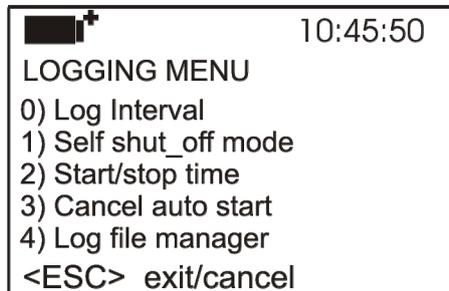
Si può impostare la cadenza di acquisizione dei dati (**Log interval**) e l'avvio automatico del logging (**Start/stop time**). **L'intervallo di acquisizione è unico per tutte le sonde.**
