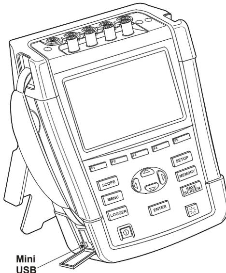
**Figura 25-1. Ubicazione del connettore dell'interfaccia USB**
