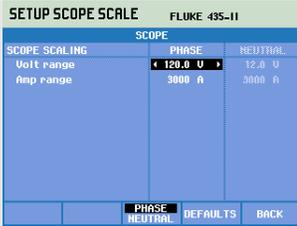
Premere il tasto funzione F2 per accedere alla schermata della scala dell'oscilloscopio.
