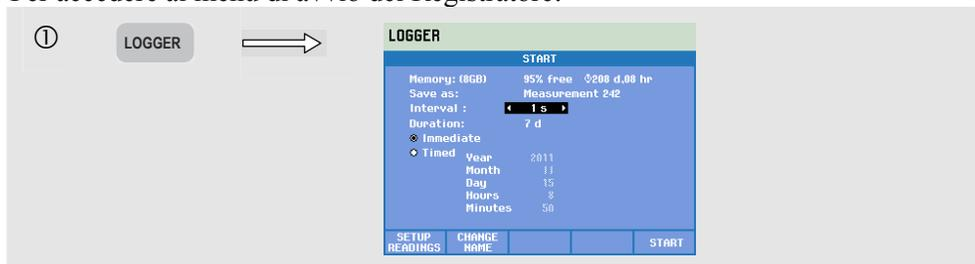
È possibile selezionare il gruppo di letture che si desidera registrare nel menu visualizzato con il tasto funzione F1 – IMPOSTA LETTURE. L'elenco di selezione delle letture per la frequenza predefinita 50/60 Hz e 400 Hz è differente. Se si modifica la frequenza predefinita a 400 Hz oppure da 400 Hz a 50/60 Hz l'elenco di selezione delle letture verrà impostato sull'impostazione predefinita!
