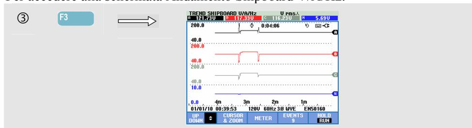
Tutti i valori della schermata del misuratore vengono registrati, ma gli andamenti di ciascuna riga in tale schermata vengono visualizzati uno per volta. Premere il tasto funzione F1 per assegnare i tasti freccia su/giù alla selezione della riga.
