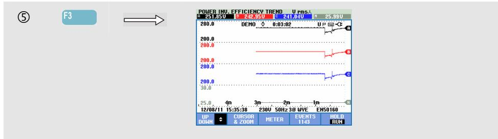
Tutti i valori della schermata del misuratore vengono registrati, ma gli andamenti di ciascuna riga in tale schermata vengono visualizzati uno per volta. Premere il tasto funzione F1 per assegnare i tasti freccia su/giù alla selezione della riga.
