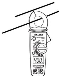
1. Impostare il selettore sul campo **400ADC, 40ADC, 400AAC o 40AAC**. Se il campo della misura non è noto, selezionare prima il campo più elevato, poi spostarsi ad un campo più basso se necessario.
