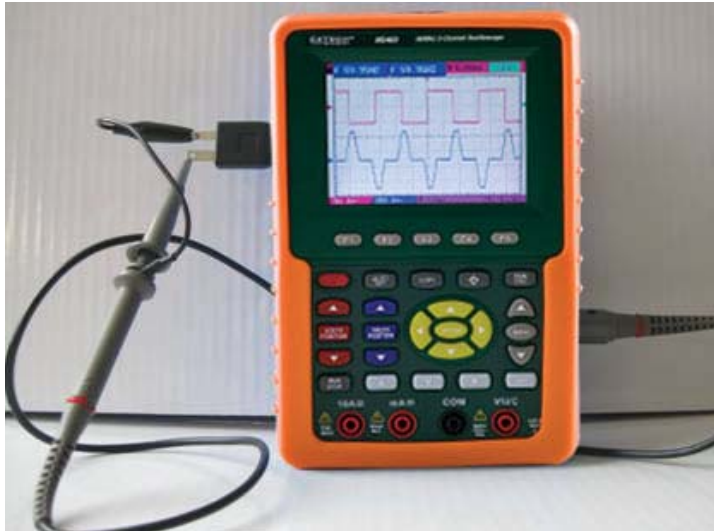
Fig 39: Segnale di misura dell'onda quadra
