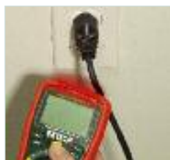
Rilevatore integrato di tensione senza-contatto — controlla rapidamente la presenza di fili attivi prima del test
