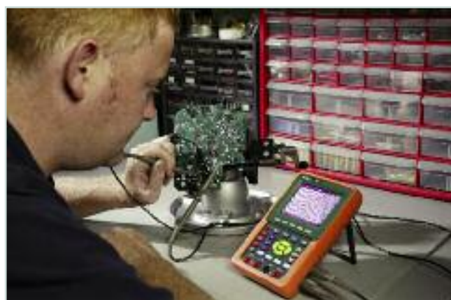
Test a doppia traccia o doppi punti di un circuito stampato di scheda elettronica
