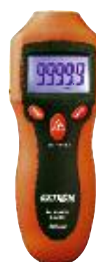
La funzione del contatore registra il numero di oggetti passanti su un nastro trasportatore
