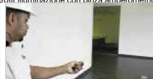
Misuratore di distanze laser con strumenti integrati per un rapido calcolo dell'area anche in punti difficili da misurare
