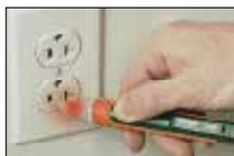
• LED rosso lampeggiante con cicalino per indicare la presenza di cavi elettrificati.
