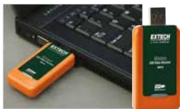
Il ricevitore video USB wireless opzionale consente di inviare il video streaming in diretta ad un PC, visionabile anche remotamente tramite una connessione VOIP.
