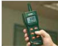
Misura il livello di CO<sub>2</sub> in edifici di uffici per controllarne corretta ventilazione.
