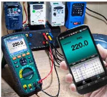
Visualizzazione delle letture elettriche, acquisite dal GX900 a distanza di sicurezza, sul dispositivo Android. Per accendere le apparecchiature tramite interruttori remoti o utilizzare l'Android per mostrare le letture ad un cliente/responsabile. Scaricare l'App Extech GX900 ExView™ da play.google.com.
