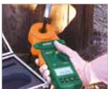
Controllo della resistenza delle reti di messa a terra di tralicci per telefonia cellulare e comunicazioni radio
