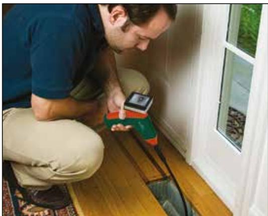
**Monitor LCD wireless a colori da 3,5" separabile, visualizzabile da una postazione remota, a distanze fino a 10 m dal punto di misurazione**
