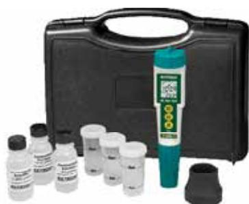
**Sensore molto accurato multigamma che misura conduttività, TDS (residuo fisso), salinità e temperatura**
