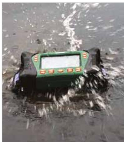
L'involucro a prova di cadute e impermeabile soddisfa lo standard IP67.
