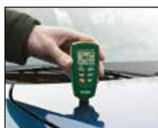
Misurazione dello spessore della vernice di una vettura
