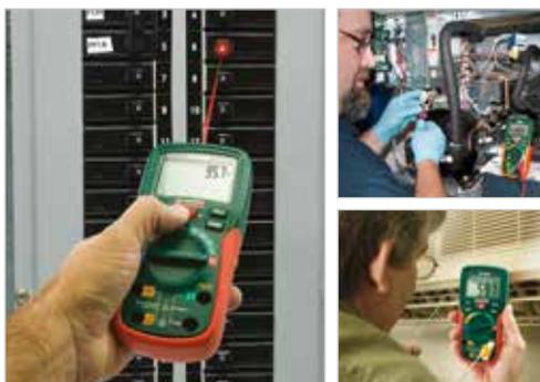
**Modelli con termometro ad infrarossi incorporato per identificare rapidamente motori surriscaldati o localizzare punti caldi su quadri elettrici e bocchette di ventilazione HVAC senza contatto**
