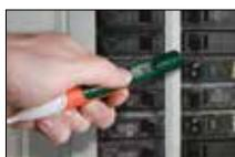
Misurazione della temperatura ad infrarossi senza contatto
