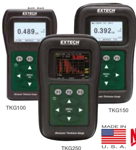
**Involucro compatto e robusto, ideale per l'uso sul campo; tecnologia a ultrasuoni per effettuare misure di spessore non distruttive principalmente su strutture in acciaio**
