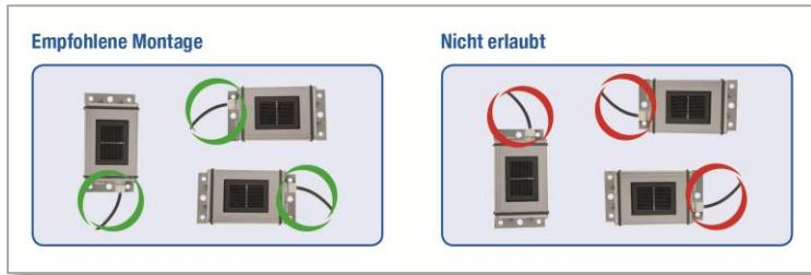
Bitte achten Sie bei der Montage des Sensors darauf, das Anschlusskabel entsprechend der Zeichnung anzugeben.
