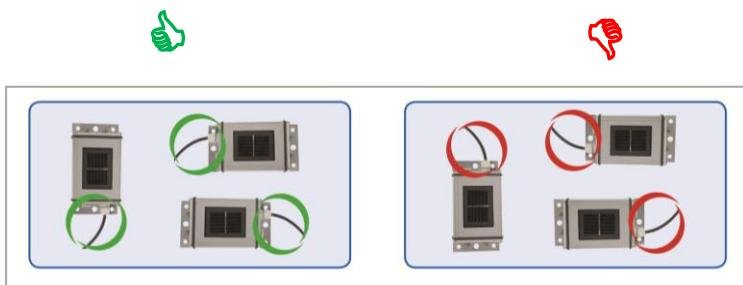
Durante il montaggio del sensore assicurarsi di sistemare il cavo di collegamento come indicato nel disegno.
