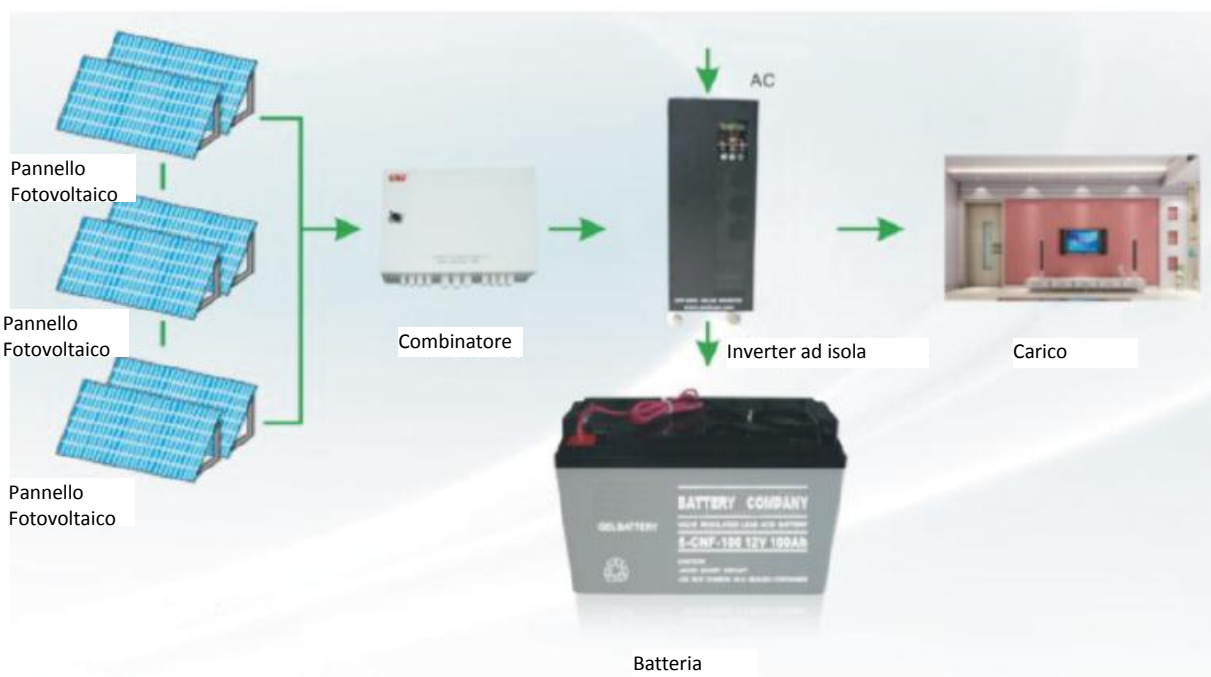
Figura 1: Diagramma schematico di un impianto fotovoltaico ad isola
