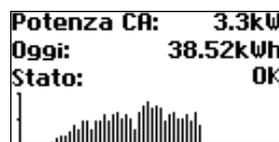
Oltre alla potenza complessiva dell'impianto aggiornata in tempo reale, è possibile vedere anche la resa energetica complessiva dell'impianto solare, nonché eventuali messaggi di stato di tutti gli apparati collegati. Questi sono contrassegnati dal numero di inverter solare. Una "M" significa che si è verificato un errore sull'apparecchio generale.
