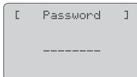
2. Immettere la password con [ ↑ ] o [ ↓ ] e confermare il valore di volta in volta immesso con [ENTER].
