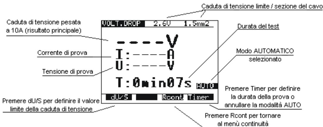
**Fig. 18. Menu principale in funzione Caduta di tensione**
