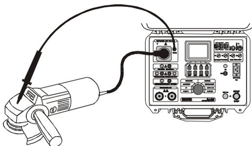
Fig. 40. Collegamento del componente TESTATO
