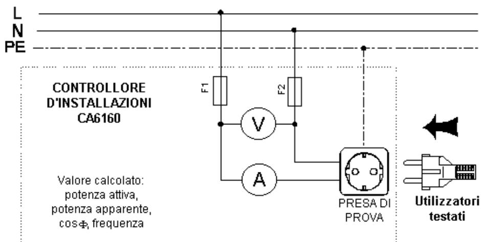
Fig. 41. Circuito di prova
