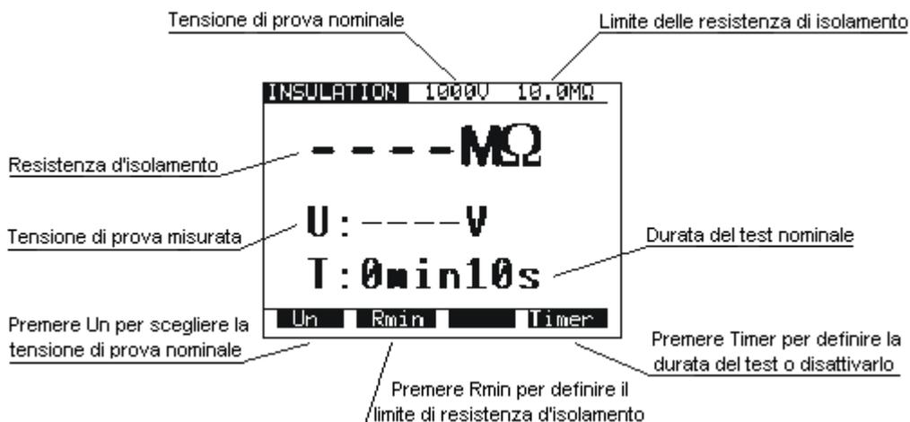
**Fig. 21.** Dati visualizzati nella funzione ISO
