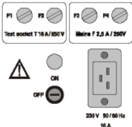
Sui FUSIBILI vi è presenza di tensioni pericolose – prima di sostituire i fusibili o aprire lo strumento, spegnere lo strumento e scollegare tutti i cavi di prova e il cavo di alimentazione.
