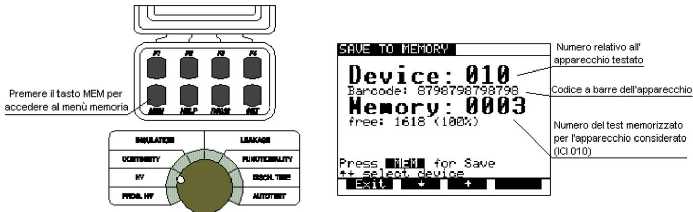
Fig. 49. Dati visualizzati per la memorizzazione dei risultati
