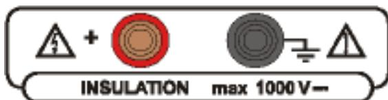
È possibile che siano presenti tensioni pericolose, le misure devono essere effettuate solo su apparecchiature scaricate e diseccitate
