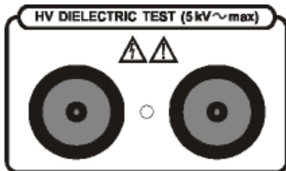
Rischio di presenza di tensioni pericolose, spegnere immediatamente lo strumento se la spia luminosa rossa d'allarme (n. 12 nella fig. 1) **non** si accende dopo aver attivato il generatore di alta tensione, quindi controllare e riparare lo strumento. Utilizzare sempre i cavetti per le prove come se fossero in tensione.
