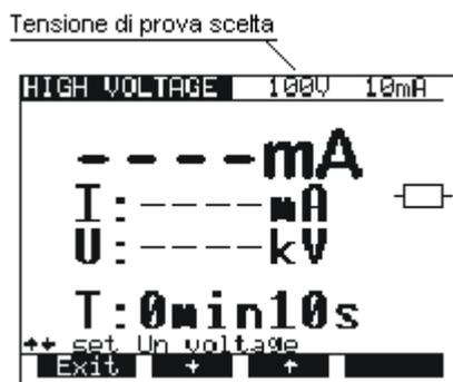
**Fig. 5. Menu per la selezione della tensione di prova**
