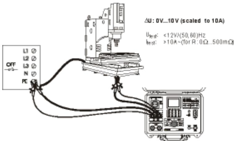
**Fig. 19.** Collegamento dei cavetti di prova
