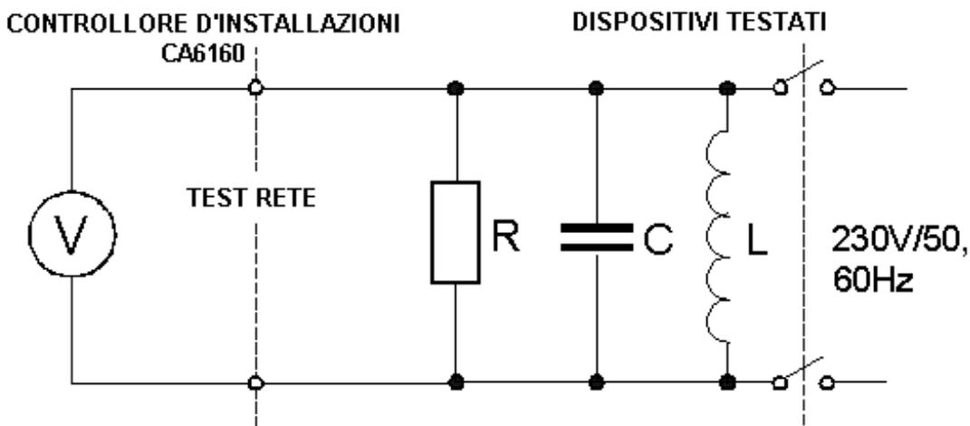
**Fig. 24. Circuito di prova**
