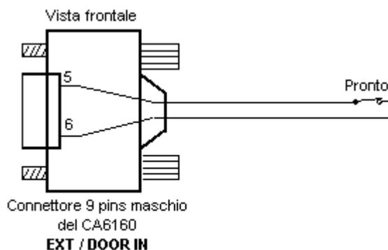
**Fig. 59. Collegamento del segnale DOOR IN al MULTITESTER**
