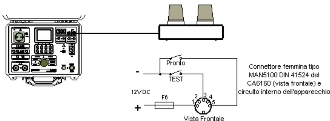
Fig. 57. Collegamento dei led di segnalazione al MULTITESTER
