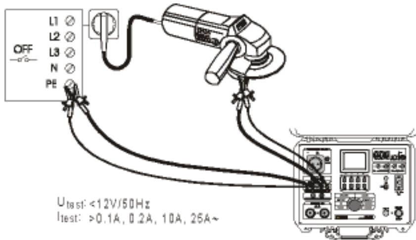
**Fig. 17. Collegamento dei cavetti di prova**
