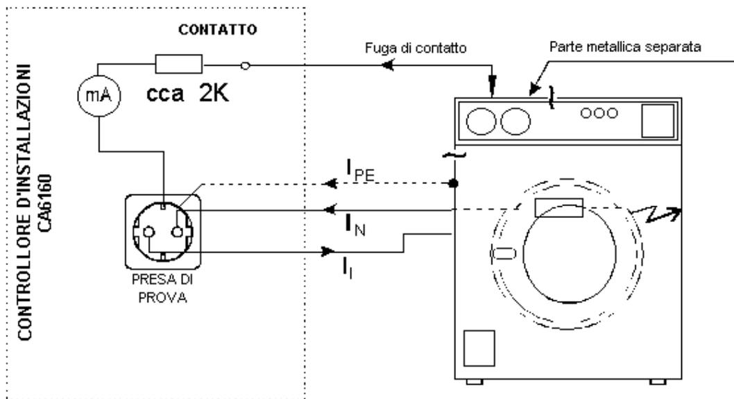
**Fig. 38. Circuito di prova per dispersione a contatto**
