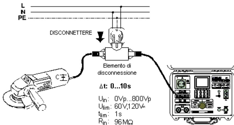
Fig. 27. Collegamento del cavo di prova
