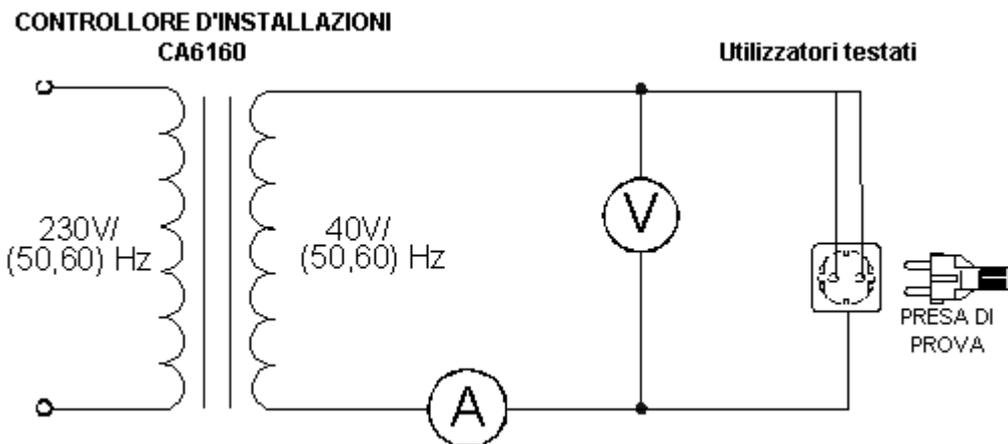
**Fig. 35. Circuito di prova**
