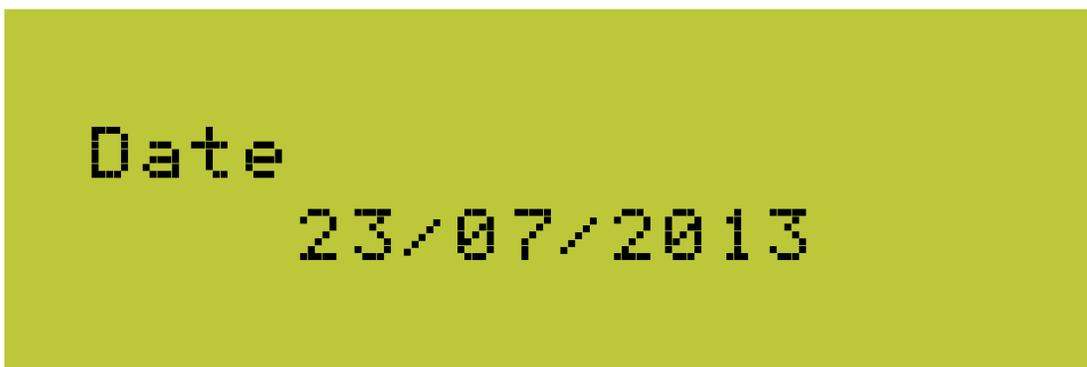
Sono mostrate I giorni, I mesi e l’anno, minuti e secondi. Usa **ENTER** per selezionare la voce da modificare e **UP** e **DOWN** per il settaggio.
