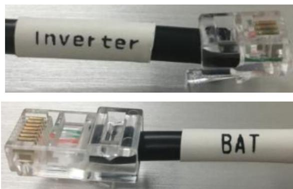
Figura 14 - Estremità del cavo di comunicazione con morsetto lato inverter e morsetto lato batteria
