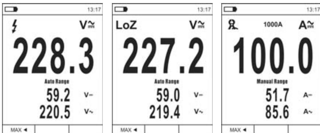
Fig. 6: Descrizione misura tensione e corrente AC+DC
