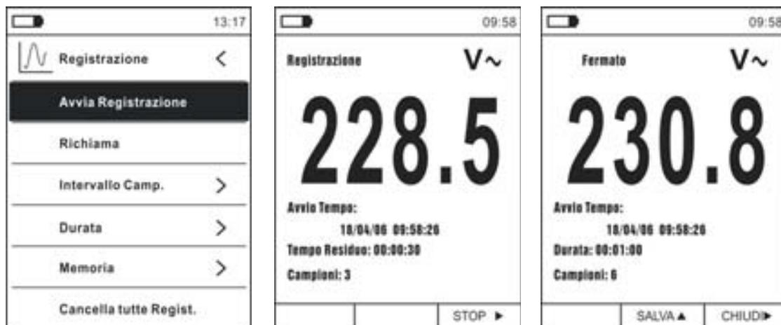
Fig. 37: Funzione data logger – Avvio e terminazione registrazione
