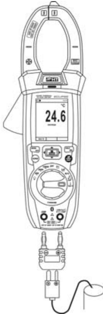
Fig. 30: Uso dello strumento per misura di Temperatura
