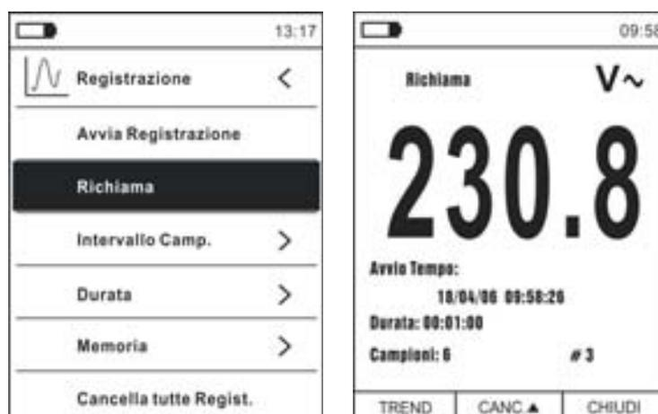
Fig. 38: Funzione data logger – Richiamo a display dati registrazione
