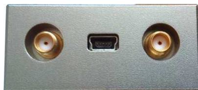
Figure 2.3 Mini B USB port
