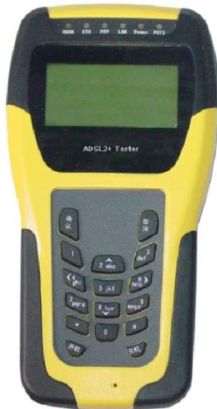
IL **332B** è un tester palmare multifunzione di piccole dimensioni per misure ADSL, progettato specificamente per misure su linee XDSL. XDSL include: ADSL, ADSL2, ADSL2+, READSL etc. IL **332B** esegue misure XDSL, misure PPPoE, PPPoA DIAL TEST,
