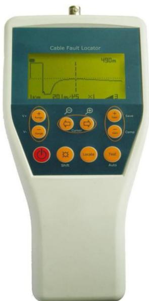
L'Comet palmare TM 800H localizzatore di guasti nei cavi, adotta il sistema TDR (Time Domain Reflection, Riflessione di impulso nel dominio dei tempi). Grazie ad un processore di ultima generazione ed ad una nuova tecnologia di elaborazione dati, si può individuare la distanza del guasto del cavo e localizzare accuratamente il punto di corto circuito o l'interruzione della linea.
