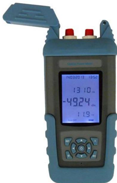
**ST 800K-U** misuratore portatile di potenza ottica è una nuova concezione tester di fibra ottica, è in grado di soddisfare i requisiti generali dei Test per l'installazione, progettazione e manutenzione della rete in fibra.
