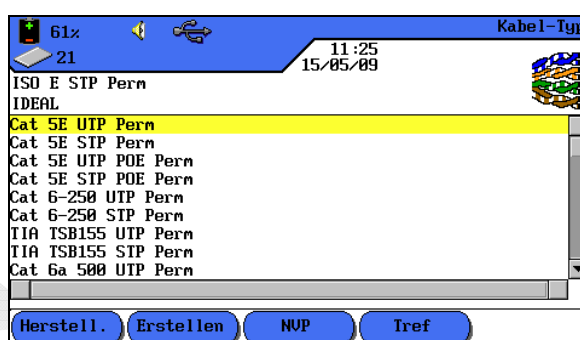
Illustrazione 2 5.8. Tipo di cablaggio
