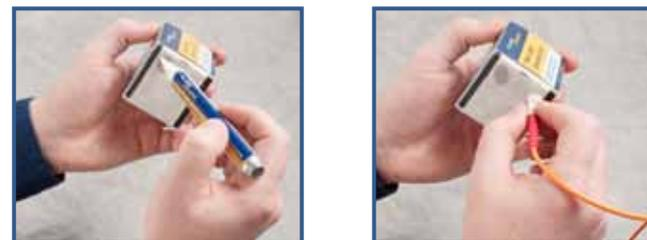
Figura 31 - Metodo di pulizia 'da umido a secco'. Mettere una piccola quantità di solvente nel punto di partenza della passata di pulizia. Tenendo la superficie terminale del connettore perpendicolare, strisciare dalla zona inumidita verso quella asciutta.
