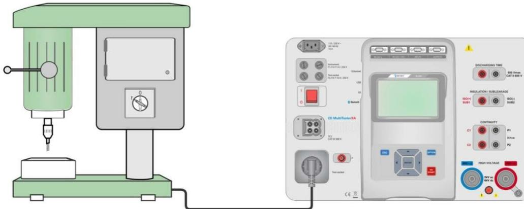
Figura 6.64: Test del tempo di scarica (uscita = presa)
