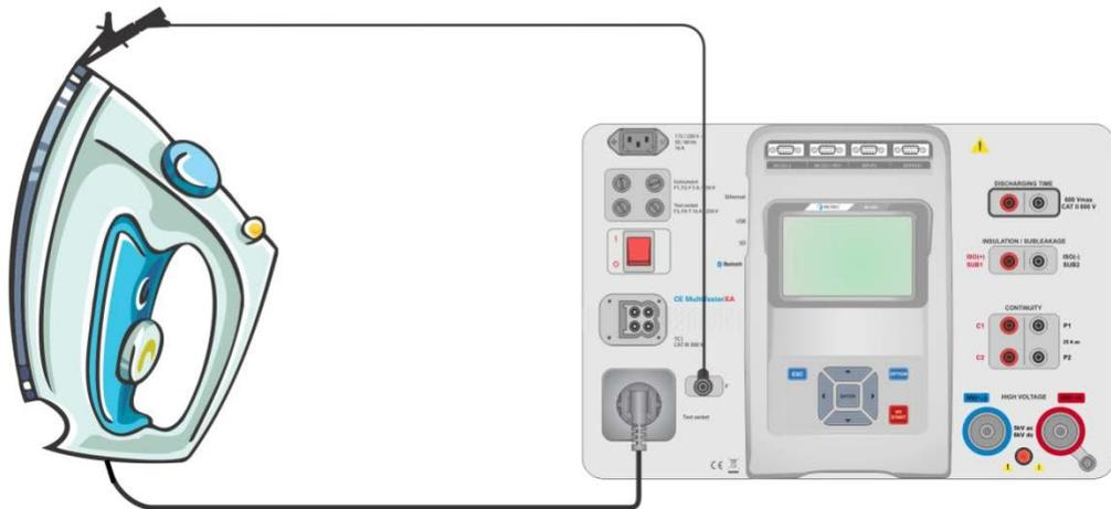
Figura 6.18: Rilevamento della continuità P/S - PE
