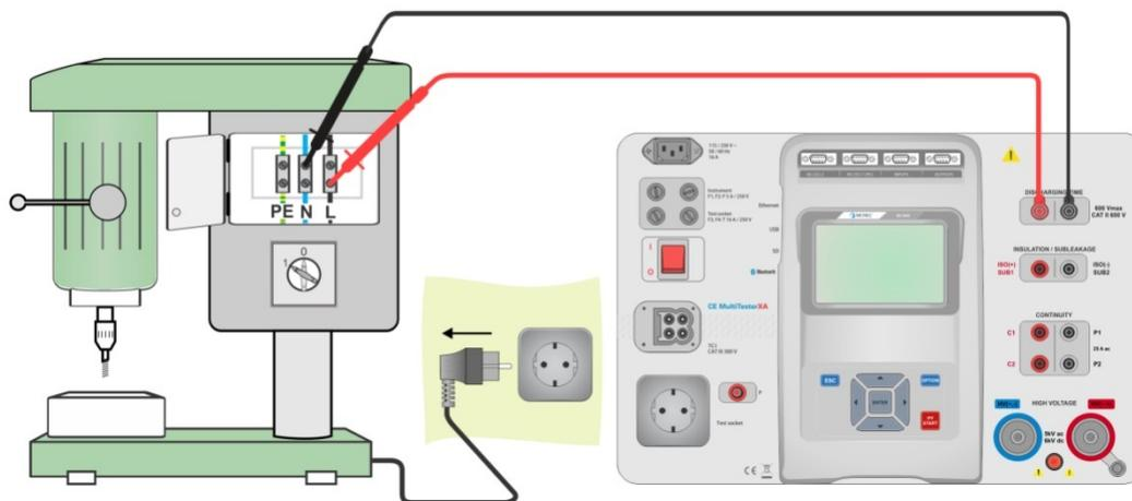
**Figura 6.62: Test del tempo di scarica (uscita = esterna)**
