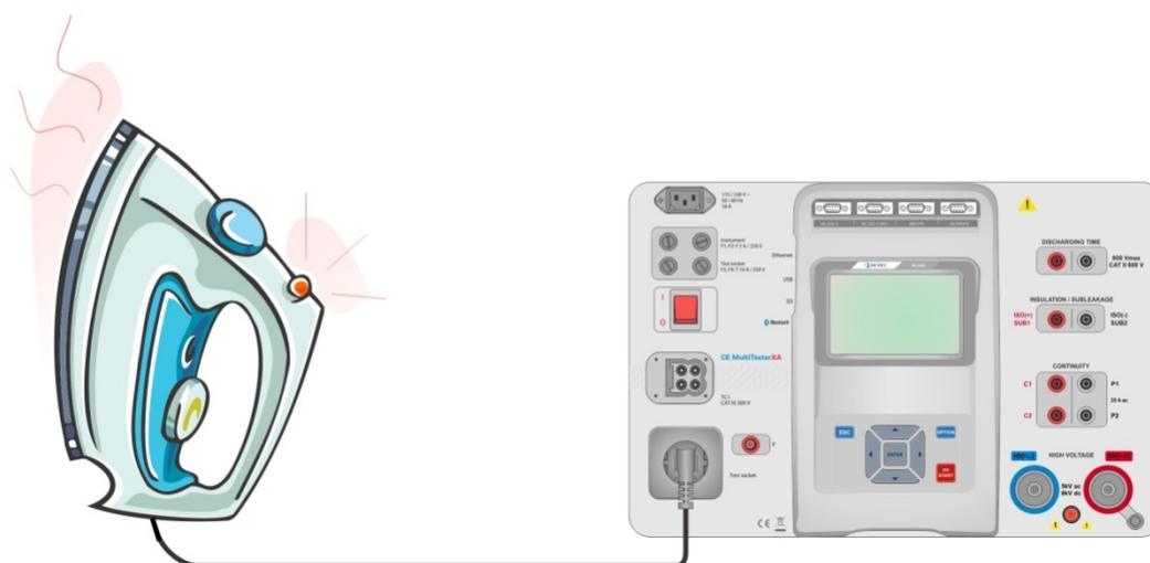
Figura 6.46: Rilevamento della corrente di dispersione differenziale
