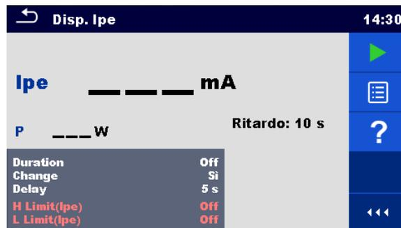
Figura 6.48: Menu di test di dispersione Ipe
