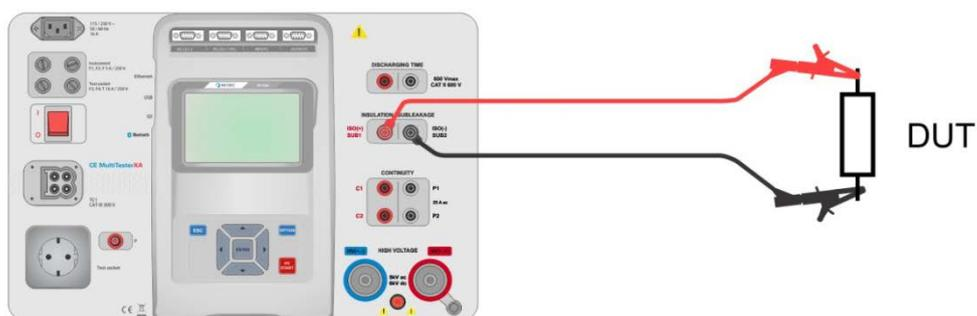
Figura 6.41: Rilevamento della sostituzione di dispersione (SUB1, SUB2)
