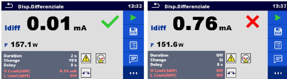
Figura 6.47: Esempi di risultati del rilevamento di dispersione differenziale
