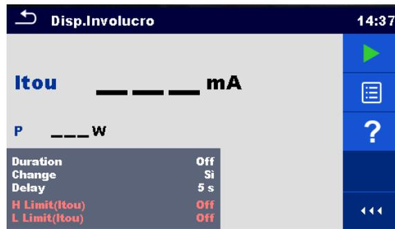
Figura 6.51: Menu di test di dispersione Ipe
