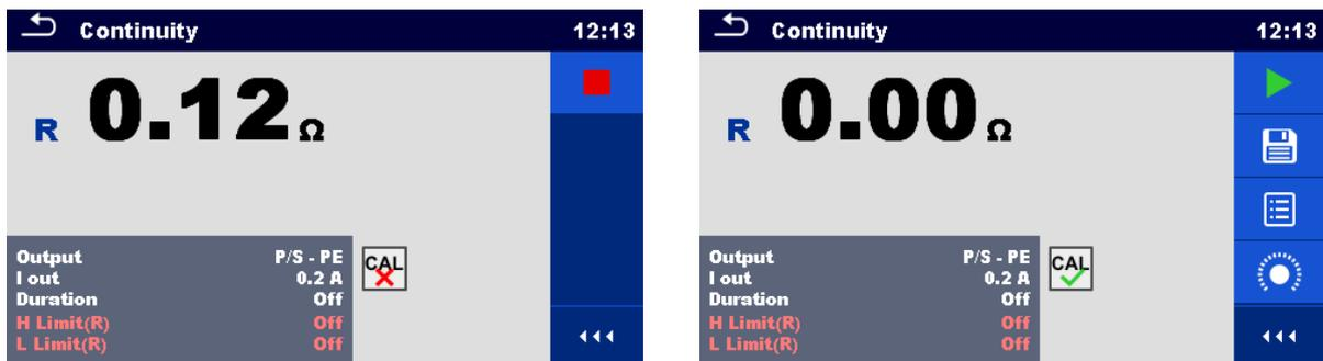
Figura 6.21: Risultato non compensato e risultato compensato
