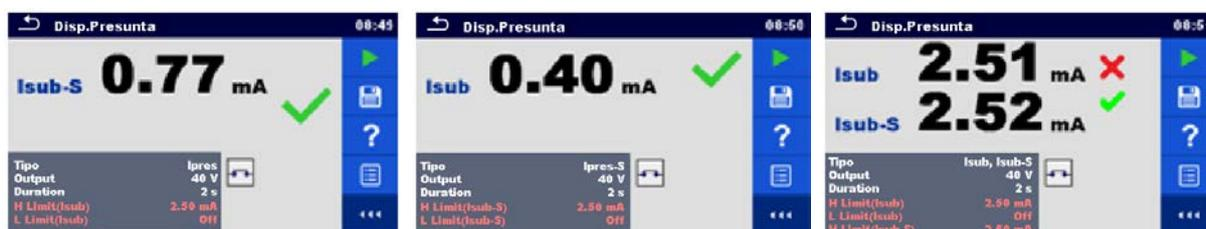
Figura 6.44: Esempi di risultati del rilevamento di sostituzione di dispersione
