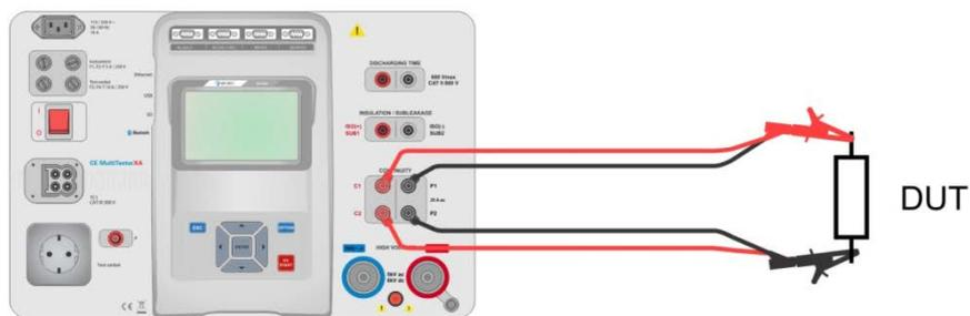
Figura 6.17: Rilevamento della continuità a 4 cavi
