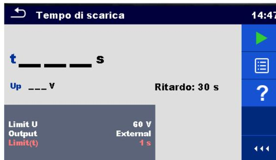
Figura 6.60: Menu test tempo di scarica
