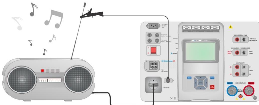
Figura 6.52: Rilevamento della corrente di dispersione da contatto
