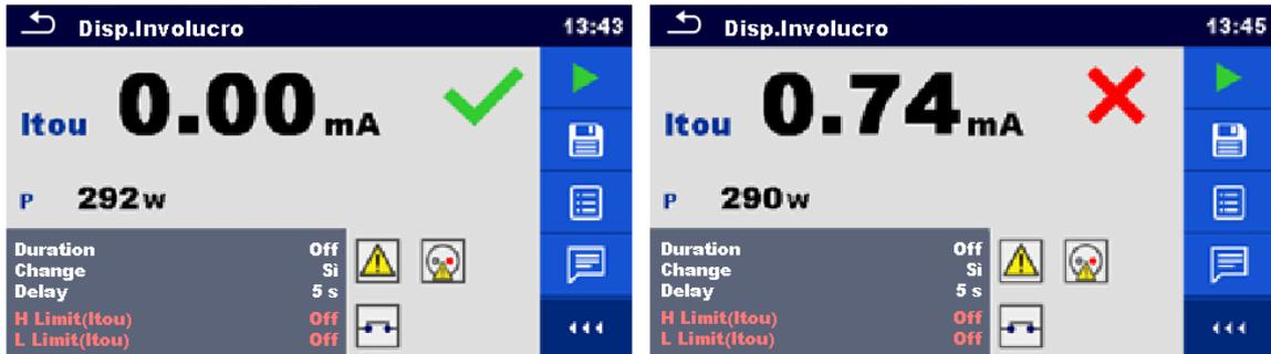
Figura 6.53: Esempi di risultati del rilevamento di dispersione da contatto
