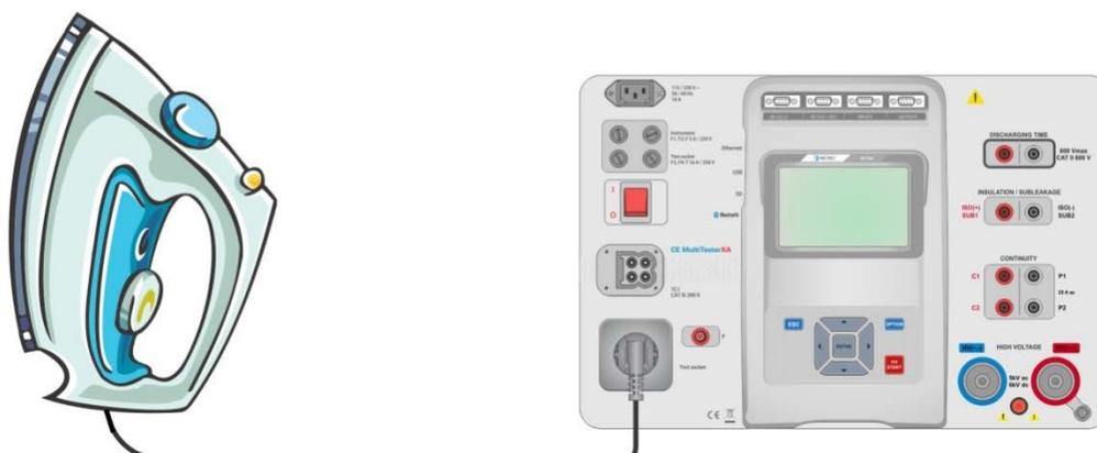
Figura 6.37: Rilevamento della resistenza di isolamento (Preso LN - PE)
