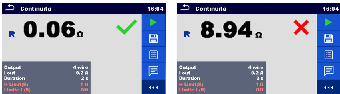
Figura 6.19: Esempi di risultati del rilevamento della continuità.
