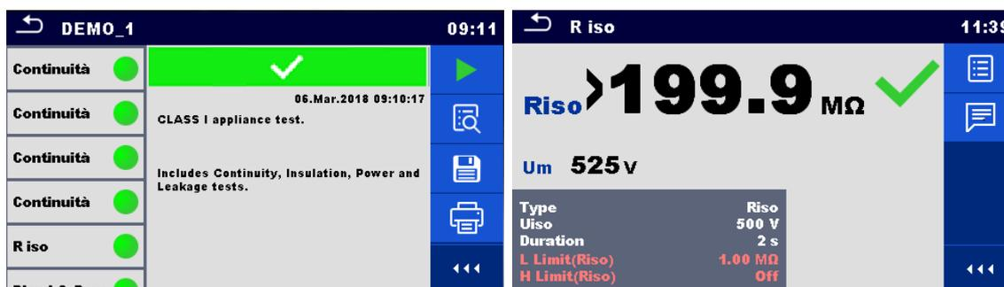
Figura 7.9: Dettagli delle schermate del menu dei risultati di Auto Sequences®
