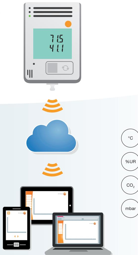
Il data logger WiFi testo 160 IAQ controlla i parametri climatici temperatura, umidità, pressione atmosferica e concentrazione di CO<sub>2</sub> negli ambienti di edifici pubblici, complessi per uffici e scuole. Il data logger trasmette i valori di misura tramite la rete WLAN all'archivio online (Testo Cloud).
