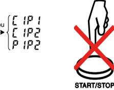
...premere il bottone START/STOP è senza effetto, la misura è impossibile. Sopprimere la tensione per effettuare la misura.
