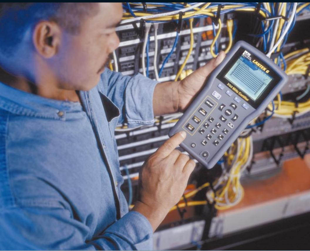
LANTEK 6 è un tester pienamente conforme alla Categoria 6/ISO E con una gamma di frequenza fino a 350MHz. È in grado di eseguire un completo Autotest di Categoria 6/ISO E con grafici in circa 25 secondi, offrendovi la massima efficienza. Inoltre con la possibilità di aggiornare il LANTEK 6 come LANTEK 7 avrete tutta la flessibilità necessaria per far fronte alla continua evoluzione degli standard.
