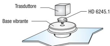
**Fig. 3: Fissaggio del trasduttore mediante incollaggio**
