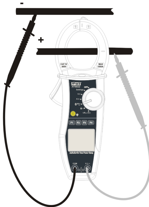
Fig. 11: misura di Potenza DC
