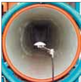
Presca di pressione statica collocata nella galleria aerodinamica
