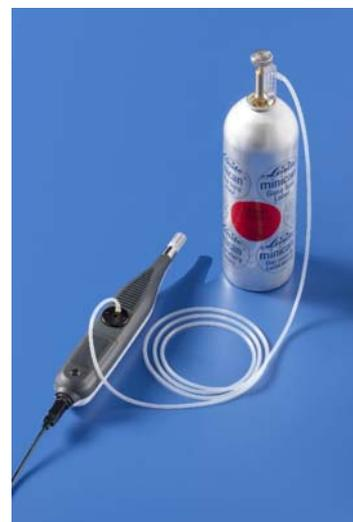
2. Nel caso si voglia eseguire la calibrazione intorno a 400 ppm lasciare l'ingresso aperto: in questa seconda procedura di taratura **assicurarsi che lo strumento sia effettivamente in aria pulita.**
