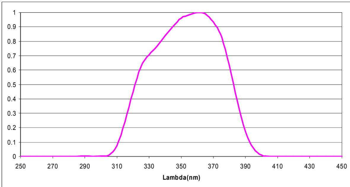
**Figura 8: curva di risposta spettrale del sensore UVA**
