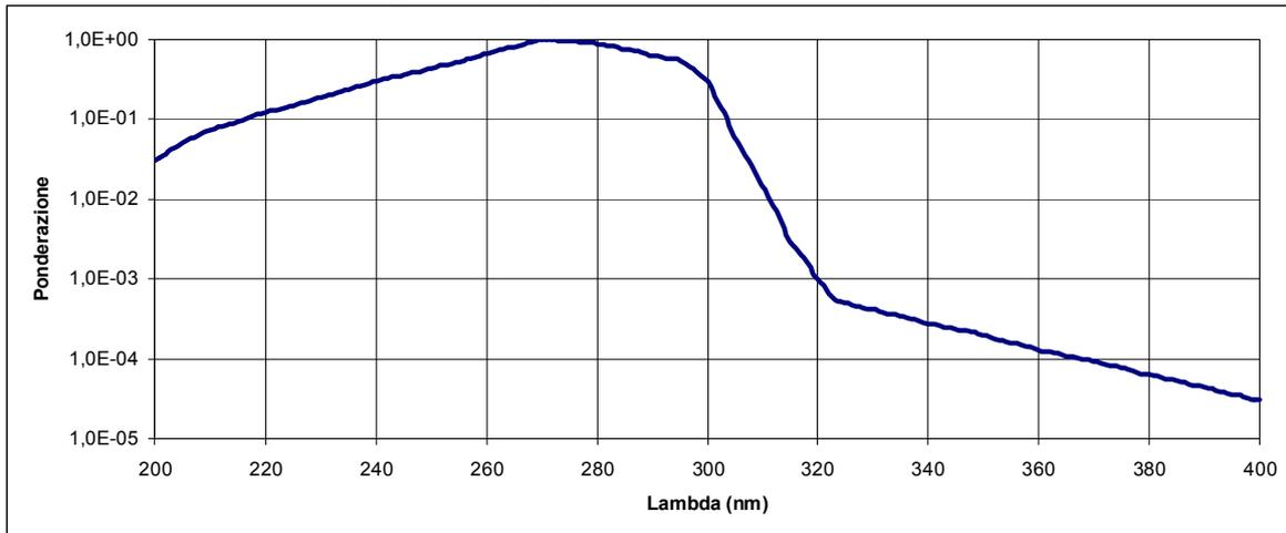
**Figura 4: Curva di ponderazione spettrale  $S(\lambda)$**  (non sono considerate le lunghezze d'onda inferiori a 200nm perché fortemente assorbite in aria)
