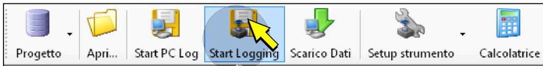
Dopo l'avvio della registrazione l'icona *Start Logging* viene sostituita dall'icona *Stop Logging*. Per arrestare manualmente la registrazione selezionare l'icona *Stop Logging* (o in alternativa premere per 5 secondi il pulsante sul retro dello strumento). I dati vengono salvati nella cartella Logging all'interno della cartella predefinita, il file sarà identificato dagli istanti di avvio e arresto del logging.
