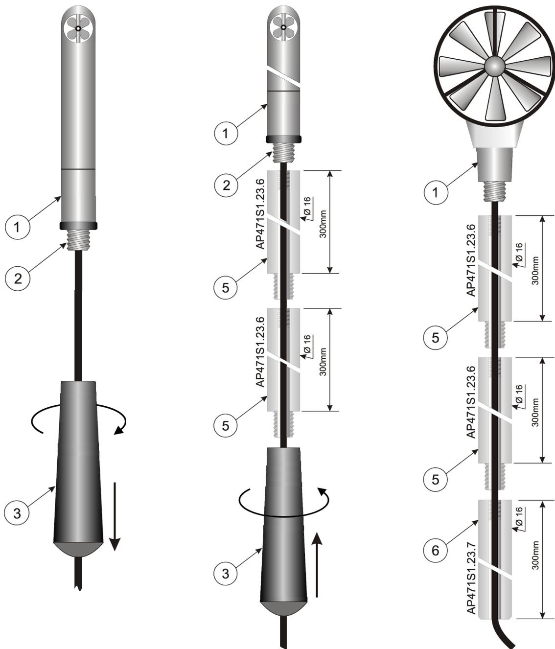
Le sonde **AP472 S1 - AP472 S2** oltre all'asta di estensione telescopica con la testa orientabile possono impiegare l'asta prolunga rigida  $\varnothing 16\text{mm}$ . Per svitare l'impugnatura (3) tenere fermo il corpo della sonda nel punto (1). Avvitare la sommità dell'asta **AP471S1.23.6** (5) sulla vite (2). E' possibile aggiungere altre aste di estensione **AP471S1.23.6**. L'ultimo elemento può essere l'impugnatura (3) o l'asta di estensione **AP471S1.23.7** (6).
