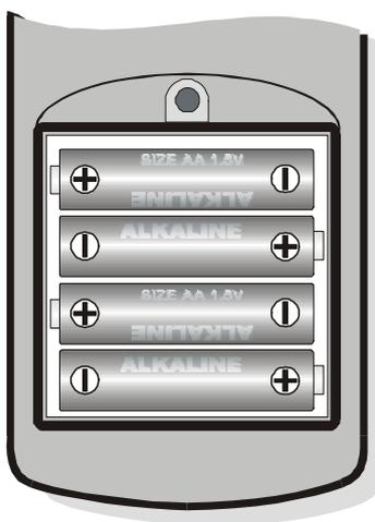
**Dopo il cambio batteria vanno reimpostati** la data, l'ora, il baud rate, il tipo di sonda, l'intervallo di stampa, i parametri di logging: **per semplificare l'operazione, all'inserimento delle nuove batterie lo strumento si accende automaticamente e richiede di seguito tutti questi parametri.** Per passare da una voce alla successiva premere il tasto ENTER; per tornare in misura, premere MENU.
