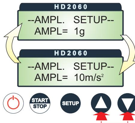
I valori di accelerazione impostabili dipendono dalla frequenza di sollecitazione selezionata. Per la frequenza di sollecitazione 15,915 Hz i valori di accelerazione impostabili sono 1 m/s<sup>2</sup> e 0,1g (0,98 m/s<sup>2</sup>). Per la frequenza di sollecitazione 159,155 Hz i valori di accelerazione impostabili sono 10 m/s<sup>2</sup> e 1g (9,81 m/s<sup>2</sup>).
