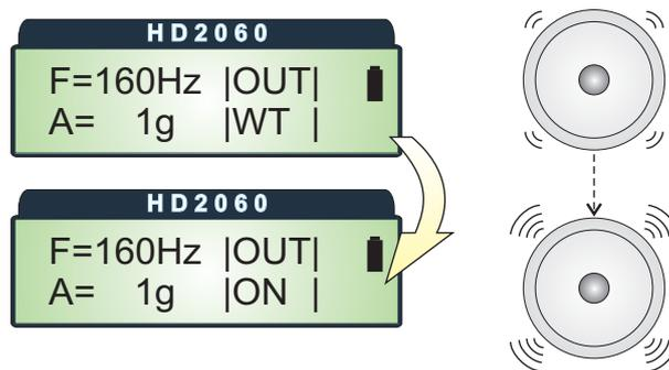
**5.** La sollecitazione si arresta automaticamente dopo il tempo impostato nel calibratore. Per arrestare manualmente la sollecitazione, premere nuovamente il tasto START/STOP.
