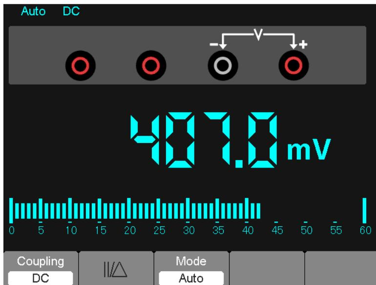
Figura 7-6 Misurazione Tensione DC
