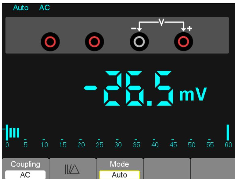
Figura 7-7 Misurazione Tensione AC
