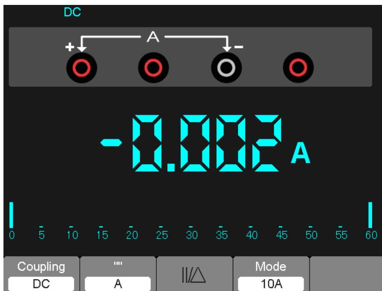
Figura 7-9 Misurazione Corrente DC per 10 A
