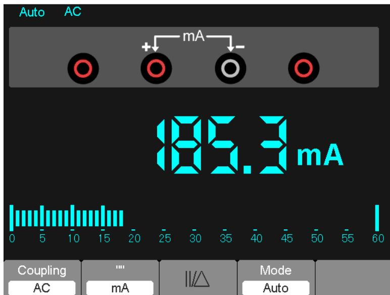
Figura 7-10 Misurazione Corrente AC per 600 mA
