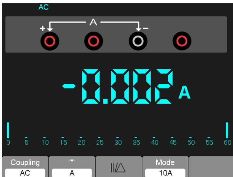
Figura 7-11 Misurazione Corrente AC per 10 A
