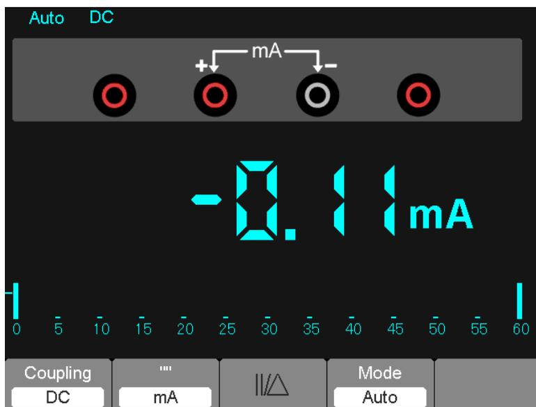
Figura 7-8 Misurazione corrente DC per 600 mA
