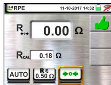
Fig. 7: Compensazione della resistenza dei cavi singoli e del puntale remoto
