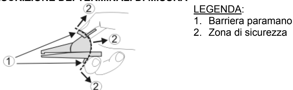
Fig. 4: Descrizione dei terminali di misura
