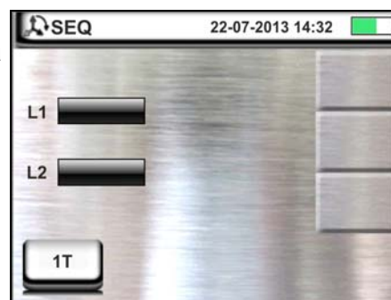
Fig. 23: Verifica del senso ciclico delle fasi 2T con terminale e puntale remoto
