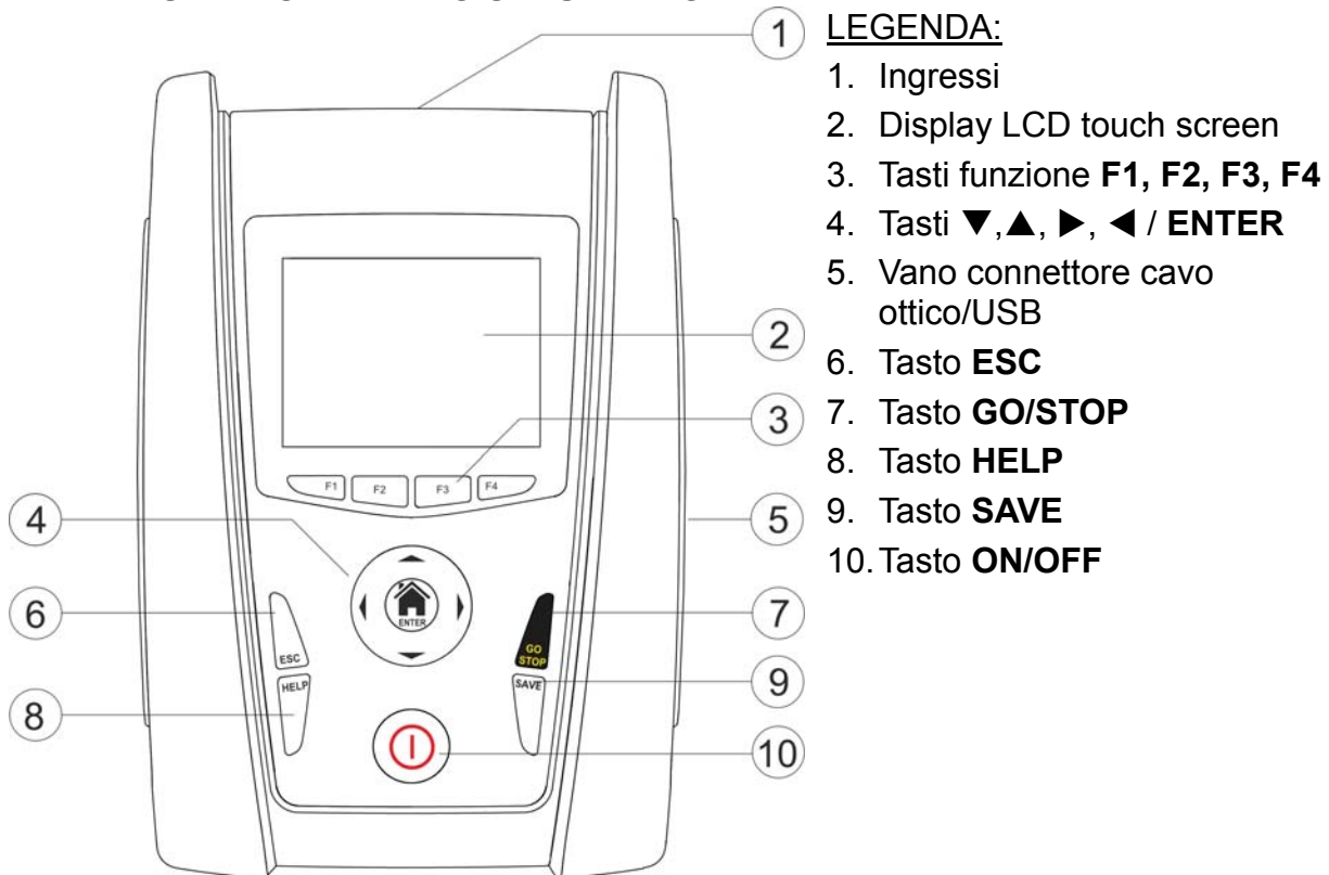
Fig. 1: Descrizione parte frontale dello strumento
