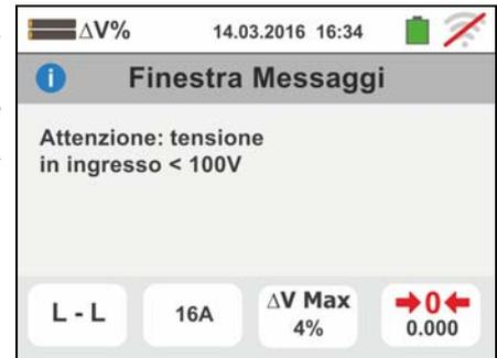
3. Se lo strumento rileva l'assenza del segnale sul terminale B1 (conduttore di fase) fornisce la videata di avviso mostrata a lato e blocca lo svolgimento delle prove
