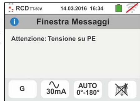
10. Se lo strumento rileva una tensione di contatto Ut pericolosa (superiore al limite impostato 25V o 50V) nella pre-prova iniziale non esegue il test e visualizza il messaggio a lato. Controllare l'efficienza del conduttore PE e dell'impianto di terra
