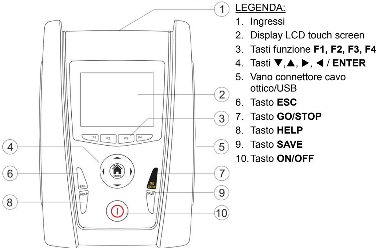
Fig. 1: Descrizione parte frontale dello strumento
