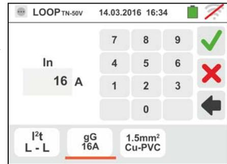
5. Toccare il campo "**mm<sup>2</sup>**" e, tramite la tastiera numerica, impostare e confermare la sezione del singolo conduttore liberamente selezionabile
