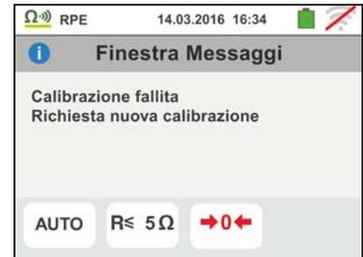
3. Qualora venga rilevato che la resistenza calibrata sia più elevata della resistenza misurata lo strumento emette un segnale acustico prolungato e visualizza una videata come quella a fianco. L'icona è mostrata a display ad indicare il valore azzerato della calibrazione
