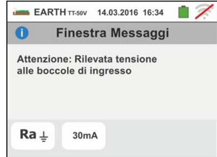
2. All'avvio della misurazione lo strumento verifica la continuità dei cavi di misura. **Qualora il circuito voltmetrico (cavi rosso S e verde ES) sia interrotto o presenti una resistenza troppo elevata**, lo strumento visualizza una videata simile a quella a fianco
