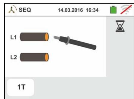
7. Il simbolo del puntale sulla fase L2 e la clessidra indicante la condizione di attesa del riconoscimento di una tensione superiore al limite massimo consentito
