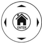
Tasti ◀ ▶ ▲ ▼ per spostare il cursore all'interno delle varie schermate allo scopo di selezionare i parametri di programmazione
