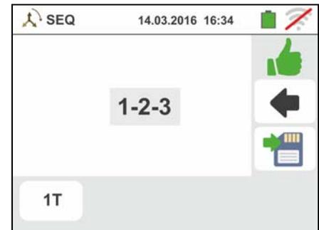
9. Al termine della prova, nel caso in cui le due tensioni rilevate fossero in fase (**concordanza di fase tra due distinti sistemi trifase**), lo strumento visualizza una videata come quella a fianco (risultato "1-1-")
