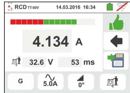
11 Al termine della prova, nel caso in cui la corrente di intervento sia superiore a quella impostata lo strumento visualizza il simbolo
