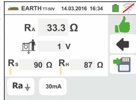
7. Per **misura di resistenza di terra nei sistemi TT** In caso di esito **negativo** (vedere § 12.7) la videata a fianco è mostrata dallo strumento in cui è presente il valore della tensione di contatto nel display secondario, il valore della resistenza di contatto della sonda di tensione ( $R_s$ ) e il valore della resistenza di contatto della sonda di corrente ( $R_h$ )
