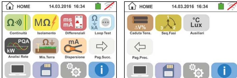
Fig. 5: Menu generale strumento
