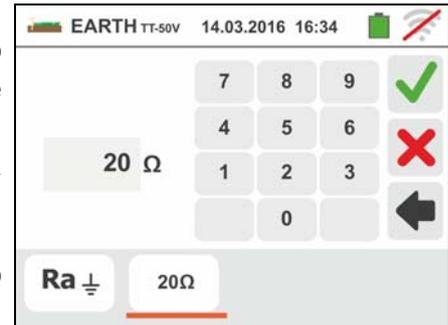
6. Premere il tasto **GO/STOP**. Durante tutta questa fase non scollegare i terminali di misura dello strumento dall'impianto in esame. Il simbolo è presente a display per tutta la durata del test.
