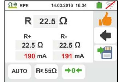
2. Qualora in modo lo strumento rilevi ai propri terminali una resistenza superiore a 2Ω azzerà il valore compensato e visualizza una videata come quella a fianco. L'icona è mostrata a display ad indicare il valore azzerato della calibrazione (es: eseguendo l'operazione con terminali aperti)
