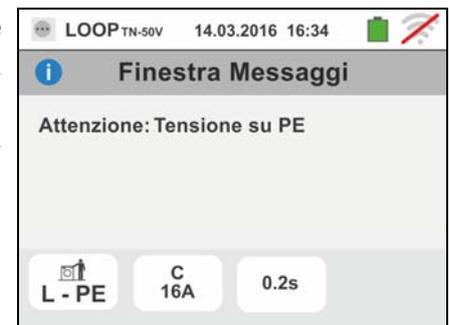
9. Qualora venga rilevata la presenza di una tensione VN-PE >50V (oppure > 25V in base alla selezione) lo strumento non effettua la prova e visualizza una videata come quella a fianco
