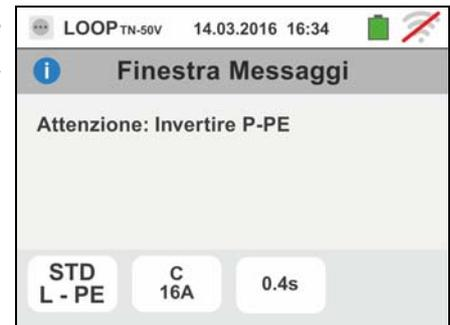
8. Qualora venga rilevata la presenza di una tensione pericolosa sul terminale PE lo strumento non effettua la prova e visualizza una videata come quella a fianco. Tale messaggio può essere visualizzato anche per una pressione insufficiente del tasto **GO/STOP**
