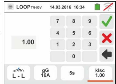
7. Scollegare, quando possibile, tutti i carichi connessi a valle del punto di misura in quanto l'impedenza dei suddetti utilizzatori potrebbe influenzare i risultati della prova. Connettere la spina shuko, i coccodrilli od il puntale remoto alla rete elettrica in accordo alle Fig. 17, Fig. 18, Fig. 19 e Fig. 21 nel punto più lontano possibile dalla protezione in esame
