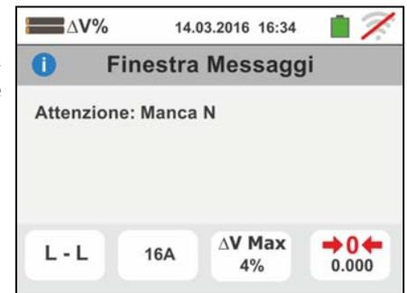
5. Se lo strumento rileva l'assenza del segnale sul terminale B3 (conduttore PE) fornisce la videata di avviso mostrata a lato e blocca lo svolgimento delle prove.
