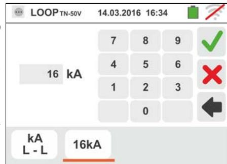
4. Scollegare, quando possibile, tutti i carichi connessi a valle del punto di misura in quanto l'impedenza dei suddetti utilizzatori potrebbe influenzare i risultati della prova. Connettere la spina shuko, i coccodrilli od il puntale remoto alla rete elettrica in accordo alle Fig. 17, Fig. 18, Fig. 19 e Fig. 21 nel punto più vicino possibile alla protezione in esame
