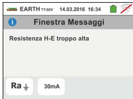
4. All'avvio della misurazione lo strumento verifica la situazione delle boccole B2 (S) e B3 (ES). In caso di inversione dei conduttori sull'impianto blocca la prova e mostra il messaggio visualizzato a lato
