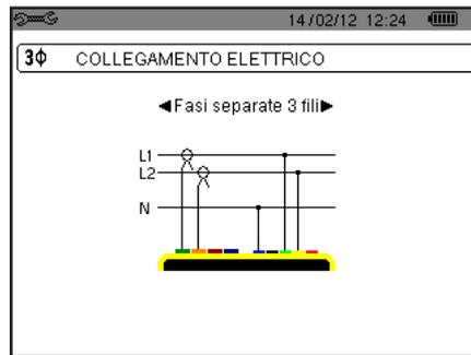
Figura 12: collegamento in bifase a 3 fili
