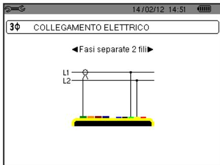
Figura 11: collegamento in bifase a 2 fili
