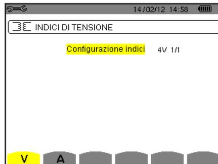
Figura 27: lo schermo Indici di tensione nel menu Sensore e indici in caso di un montaggio **con** neutro
