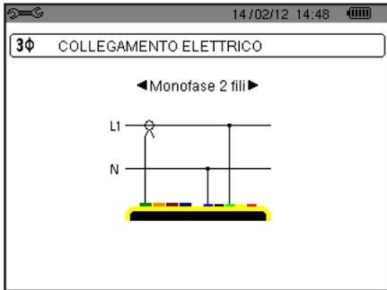
Figura 9: collegamento in monofase a 2 fili
