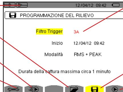
La visualizzazione in rosso del filtro d'attivazione significa che non è disponibile a causa di un'incompatibilità con la configurazione (collegamento, tipo di sensori oppure indice di corrente).
