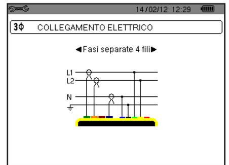
Figura 13: collegamento in bifase a 4 fili
