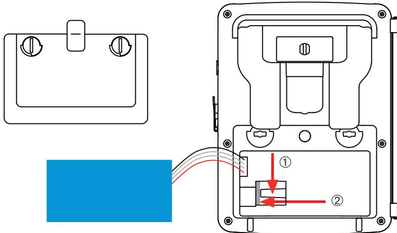
Per rimettere la scheda al suo posto, inseritela orizzontalmente nel suo alloggiamento fino a quando sarà posizionata a fondo e la linguetta sarà al suo posto. Riposizionate poi la batteria e lo sportello della pila come indicato nel §17.3.
