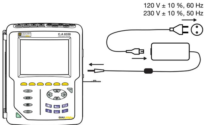
Rimuovete la protezione della presa e collegate la presa jack del blocco d'alimentazione specifica sullo strumento. Collegate il cavo di rete sul blocco d'alimentazione e sulla rete.
