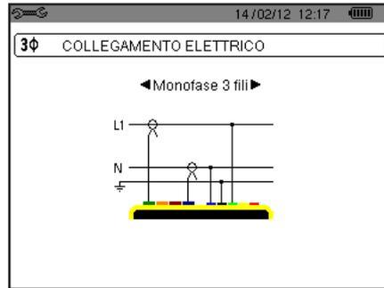
Figura 10: collegamento in monofase a 3 fili
