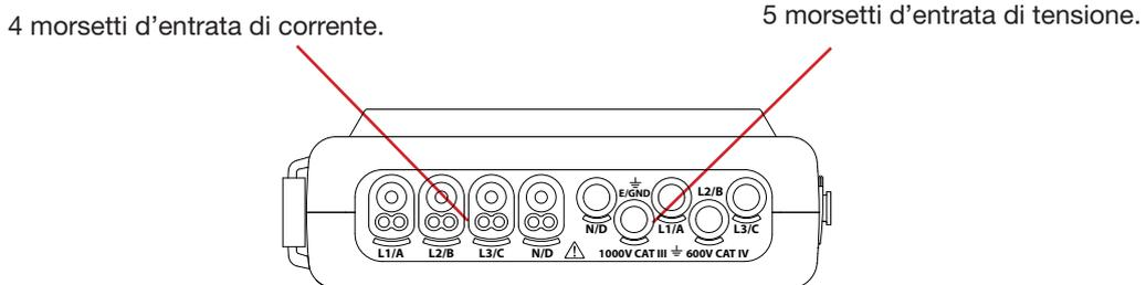
Figura 3: i morsetti di collegamento
