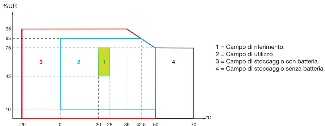
**Attenzione:** oltre 40 °C, lo strumento va utilizzato sulla batteria (sola) o sul blocco rete (solo). Si **vieta** l'utilizzo dello strumento contemporaneamente con la batteria **E** blocco rete esterna specifica.
