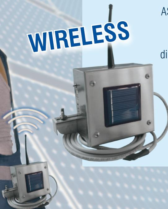
AS500CIV è dotato del **termo-solarimetro portatile SUNCEL** per la misura di irraggiamento solare e temperatura retro-pannello.
