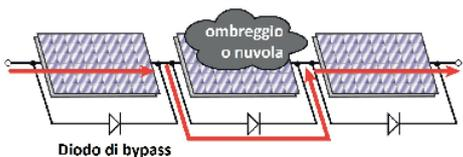
In questa condizione, il diodo di by-pass mantiene la massima efficienza di produzione, oltrepassando il pannello oscurato (o danneggiato)
