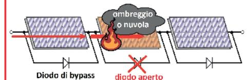
Quando il diodo di by-pass è aperto e avviene un ombreggiamento (anche parziale), la corrente è costretta a circolare sulle celle oscurate, generando elevati surriscaldamenti
