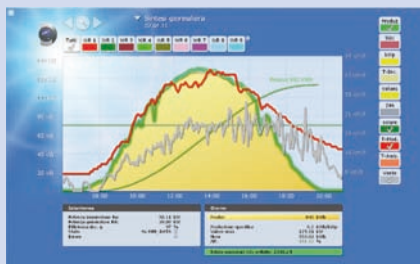
Curva giornaliera con sensore di irraggiamento (verde), sensore eolico (grigio), temperatura del modulo (rossa) e curva di rendimento (gialla)
