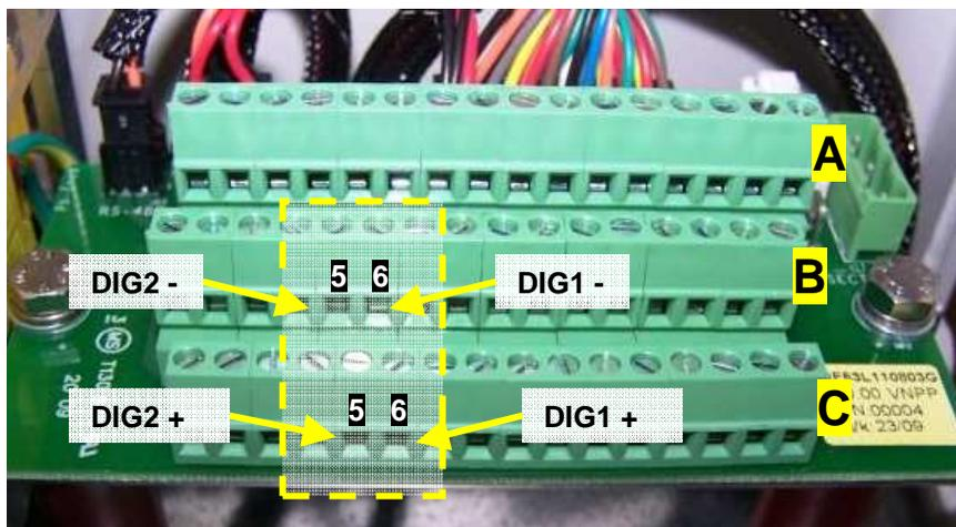
Figura 9-12: Morsetti per il collegamento Ingressi Digitali
