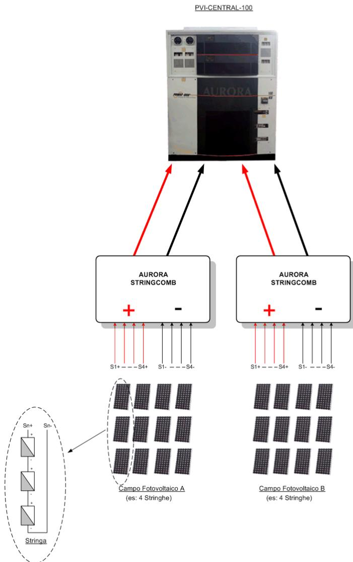
Figura 4-2: Esempio di impianto fotovoltaico
