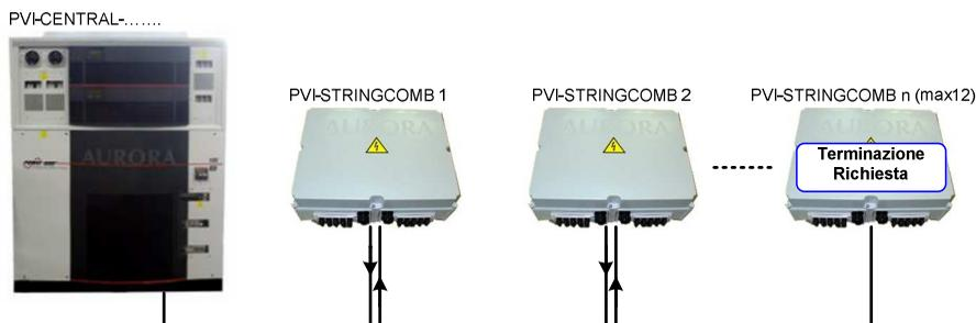
Figura 7-1: Modalità di passaggio del cavo seriale
