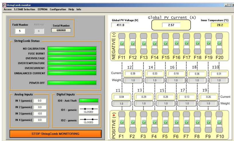
Nella prima schermata si evidenzia una condizione di funzionamento nella norma. Di seguito viene segnalata una anomalia di "overtemperature" (Rif. §12.8.1)
