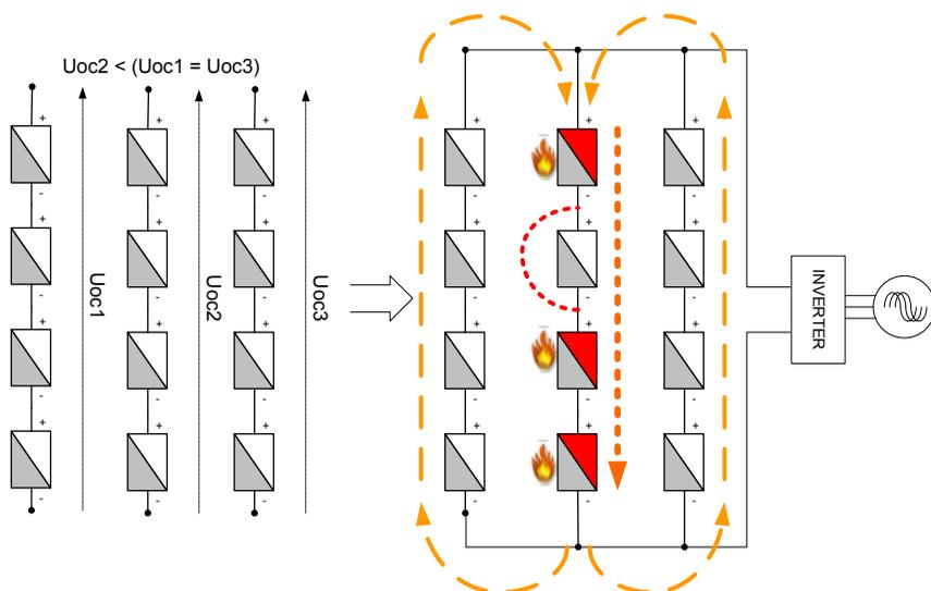
**Figura 3-1: Effetto di un guasto di un pannello in cortocircuito**
