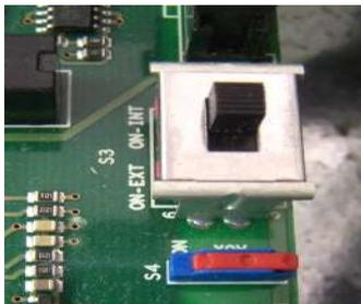
**Figura 9-15: Interruttore di selezione +24VDC esterno**
