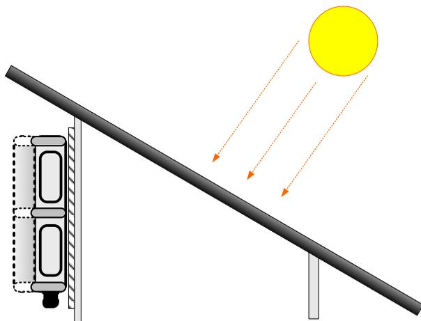
**Figura 9-1: Esempio di collocazione della cassetta**
