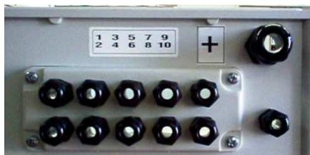
**Figura 9-18: Pressacavo per il collegamento delle stringhe positive**
