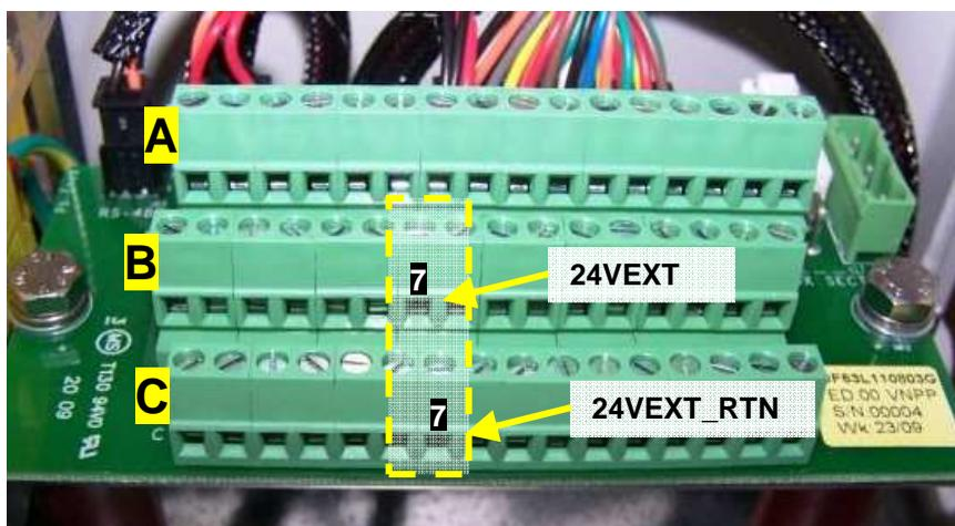
Figura 9-14: Morsetti per il collegamento +24VDC esterno
