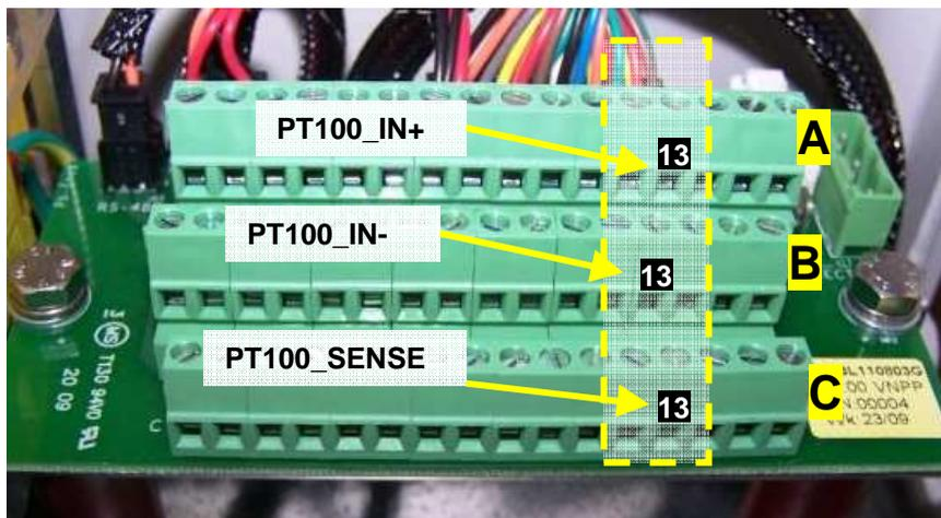
Figura 9-9: Morsetti per il collegamento della sonda PT100
