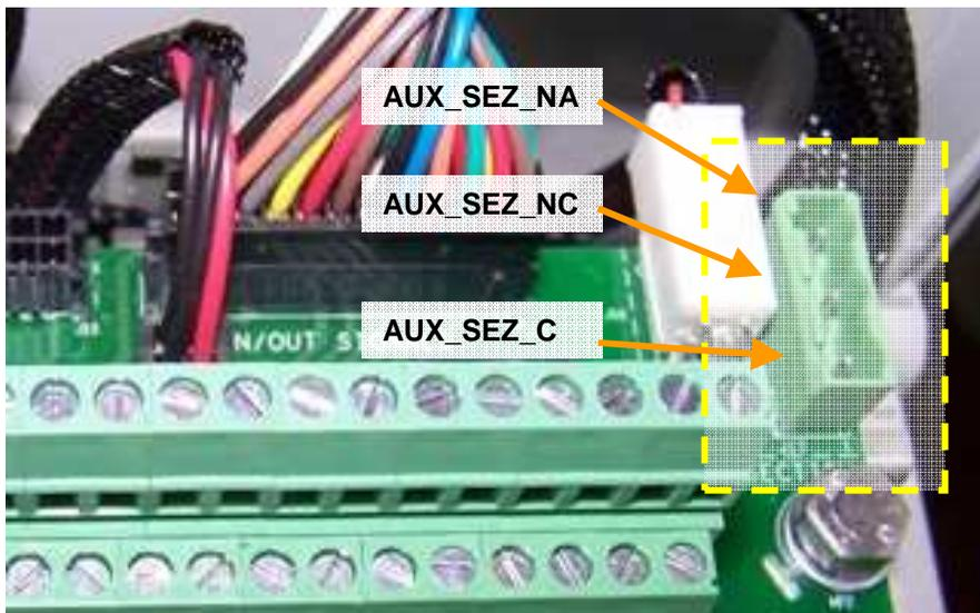
**Figura 9-16: Connettore per il controllo di stato del sezionatore**
