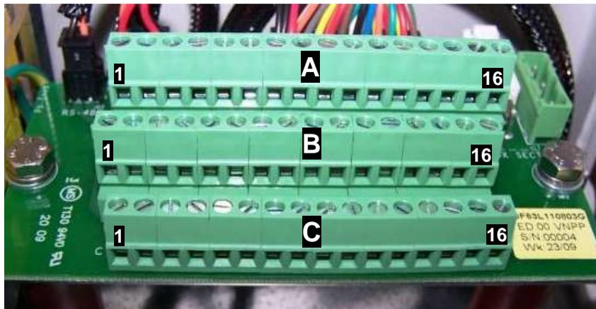
**Figura 6-5: Morsettieria per il collegamento degli ingressi analogici**
