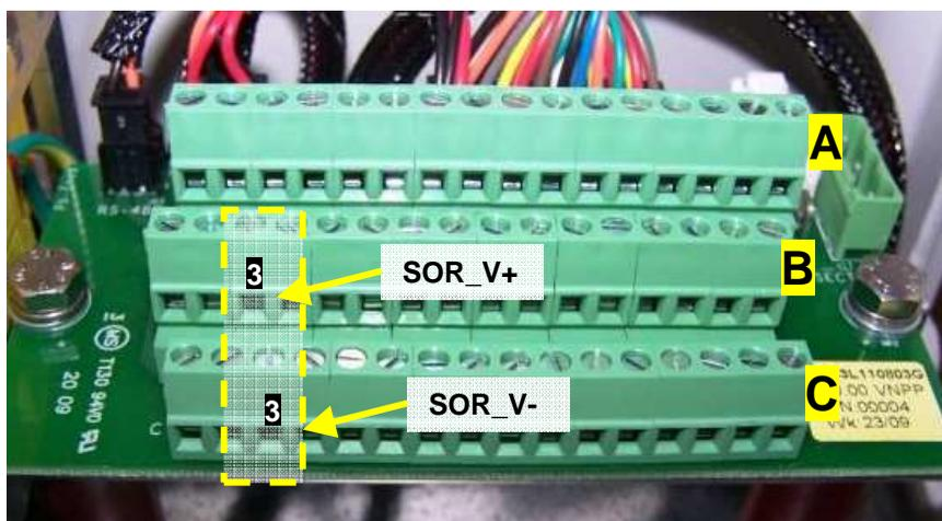
**Figura 9-13: Morsetti per il collegamento del Modulo Sgancio Remoto**
