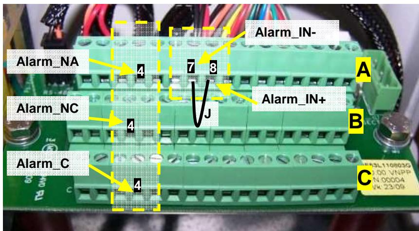
Figura 9-11: Morsetti per il collegamento Allarme Antifurto
