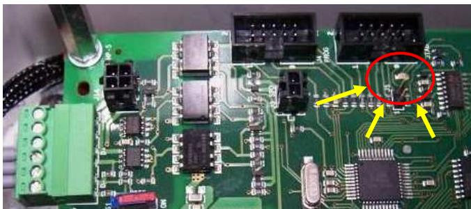
**Figura 9-21: LED di segnalazione normale funzionamento**
