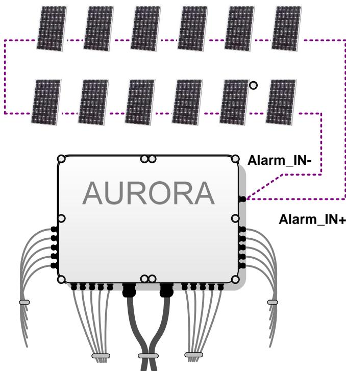
Figura 9-10: Esempio di collegamento filo antifurto
