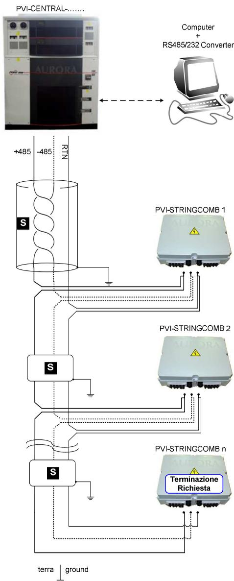
Figura 7-2: Tipologia di connessione dei PVI-STRINGCOMB(-S)
