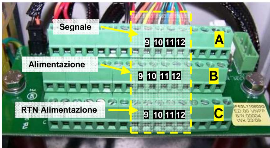
Figura 9-8: Morsetti per il collegamento degli ingressi analogici
