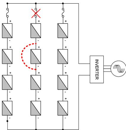
**Figura 3-2: Intervento del fusibile di protezione**
