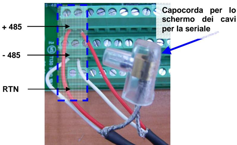
**Figura 9-6: Morsetto di terra per lo schermo della linea RS485**
