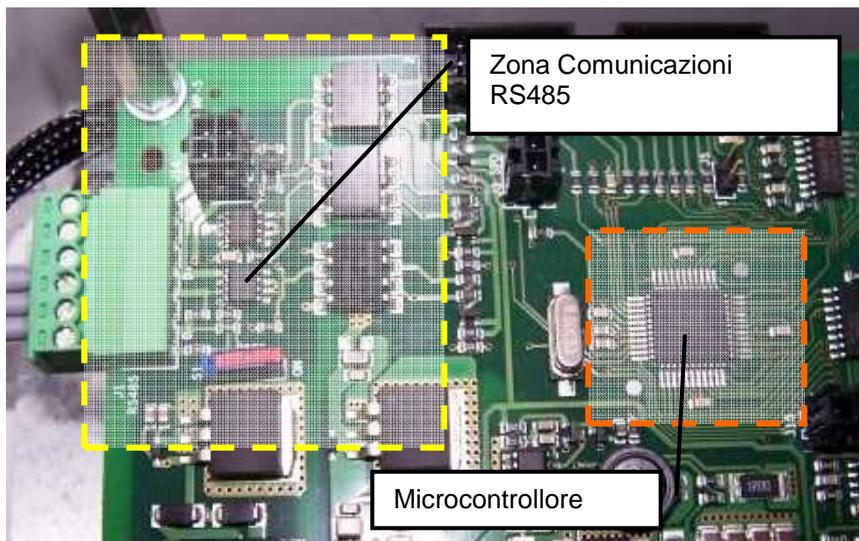
**Figura 6-7: Dettaglio zona Microcontrollore e Seriale RS485**
