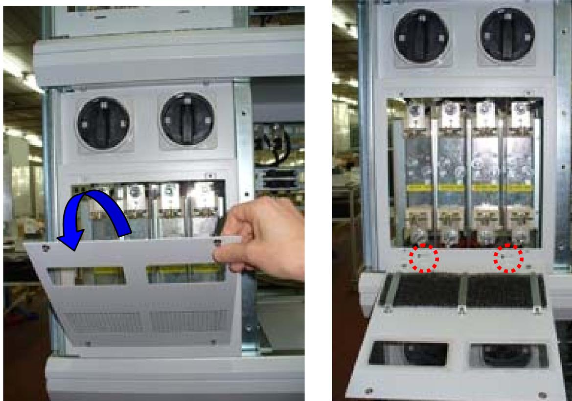
Figura 15-5- Filtro “Zona fusibili DC” (blocco meccanico)
