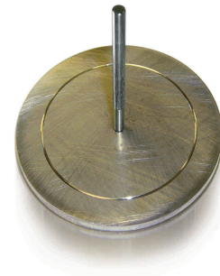
Inclinometro meccanico M304 per la rilevazione dell'angolo di incidenza solare sui moduli
